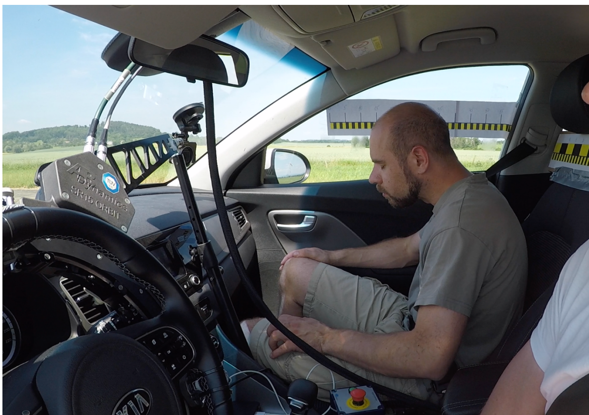
Obrázek 39 - Posun hlavy při brzdění
