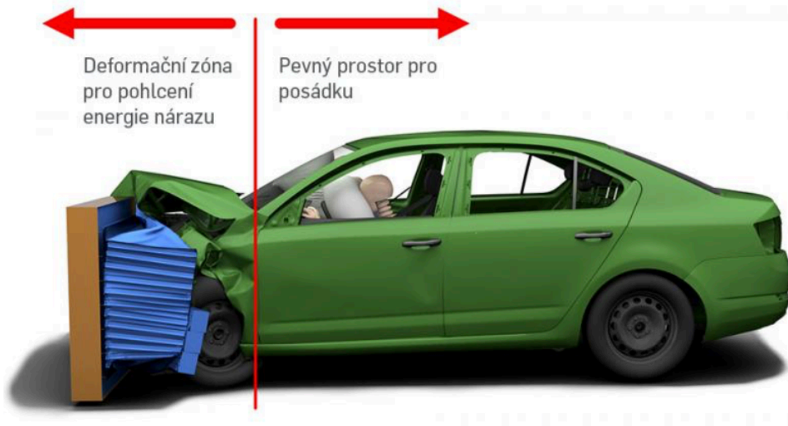
Obrázek 7 – Prostor pro přežití a prostor deformačních zón při čelní srážce [22]
