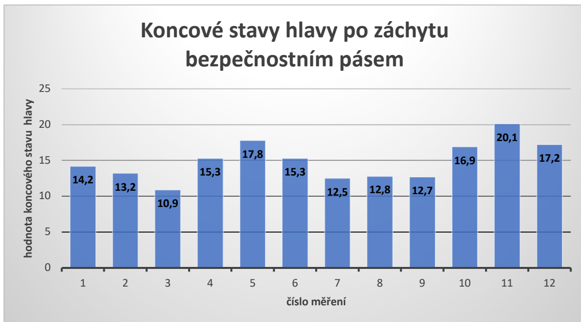
Obrázek 38 - Hodnoty koncového záchytu hlavy po nouzovém brzdění
