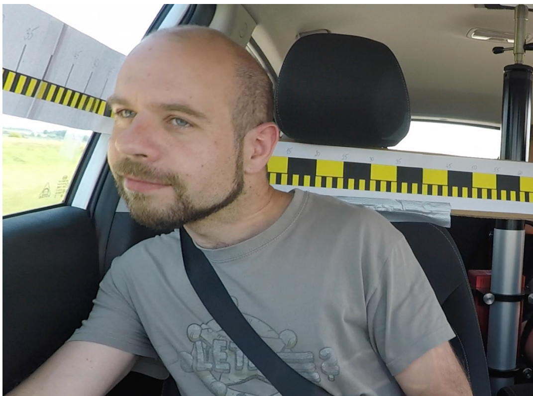
Obrázek 35 - Maximální vychýlení hlavy při úhybném manévru doprava
