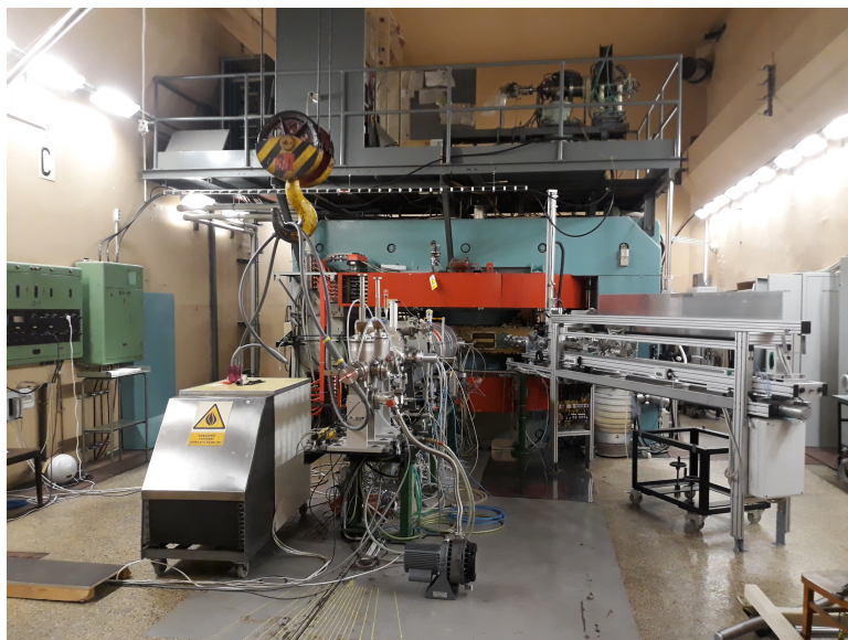
Obr. 3.2: Cyklotron U-120M s připojenou beryliovou terčovou stanicí na Ústavu jaderné fyziky AV ČR
