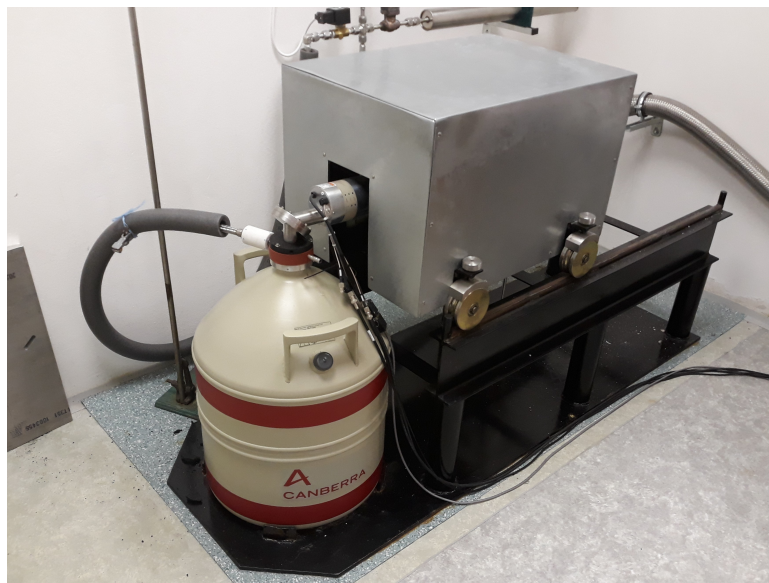
Obr. 4.9: HPGe gama spektrometrický systém Canberra během měření – dobře patrná je tzv. Dewarova nádoba obsahující tekutý dusík pro chlazení, tělo samotného detektoru a masivní olověné stínění
