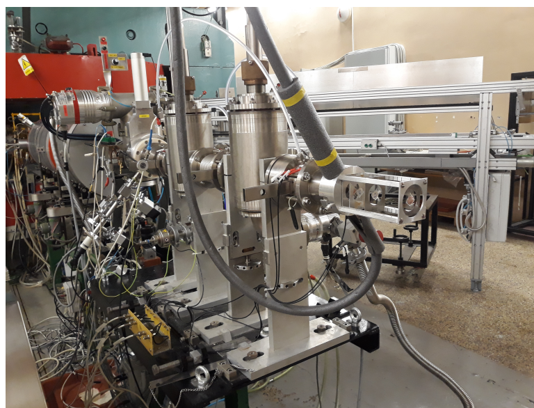
Obr. 4.8: Konfigurace ozařovacího experimentu – beryliová terčová stanice s nasazeným držákem aktivačních fólií, zapojená do soustavy s cyklotronem U-120M
