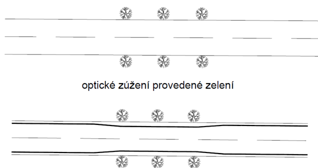
Obrázek 12: Optické zúžení pozemní komunikace pomocí prvků zeleně. [8]
