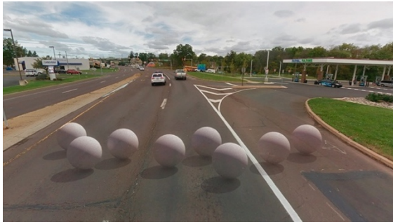
Obrázek 21: Příklad využití optické iluze na vozovce (Bethlehem Pike, Colmar). [23]
