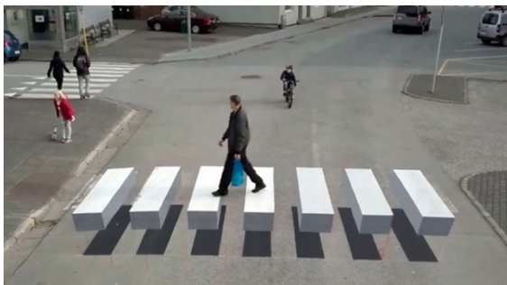
Obrázek 19: Přechod pro chodce s využitím optické iluze (Ísafjörður, Island). [22]
