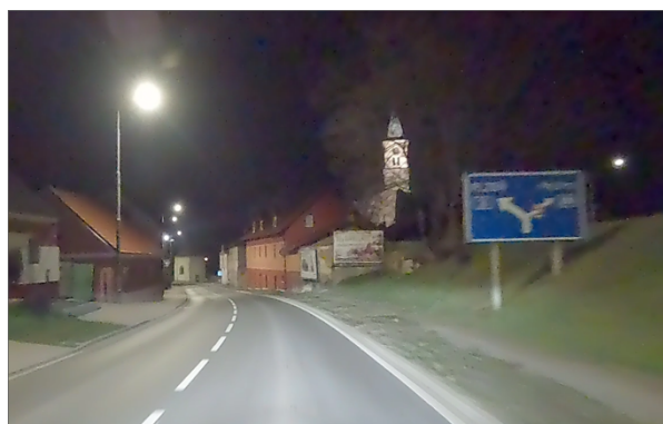
Obrázek 6 – Neodrazivé SDZ IS 9a za snížené viditelnosti. [5]
