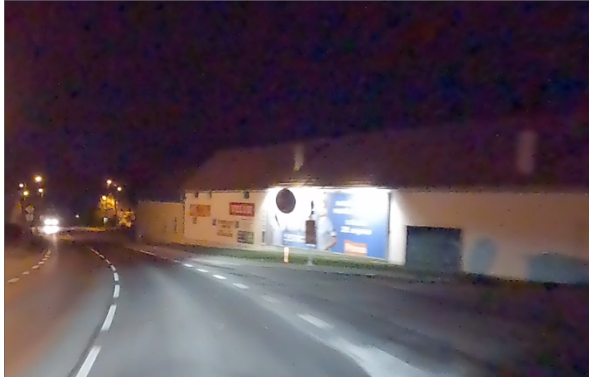
Obrázek 37 – Rušivý efekt reklamního zařízení za snížené viditelnosti. [5]
