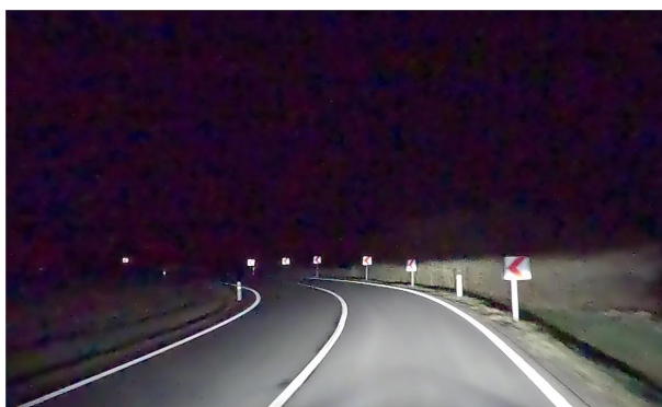
Obrázek 36 – Postřehnutelný směrový oblouk pomocí DZ Z 3. [5]
