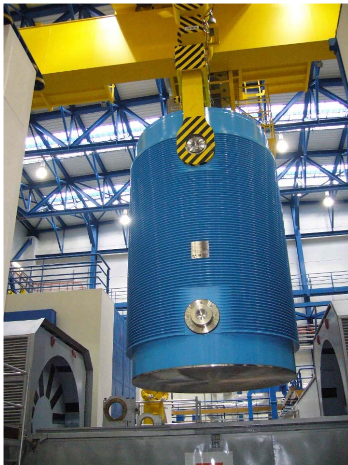
Obrázek 4: Obalový Soubor CASTOR 440/84M [10]
