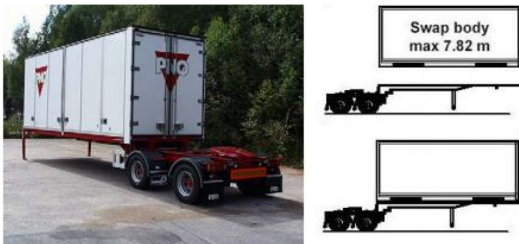
OBRÁZEK 6, VLEVO INTERLINK S VYSUNUTOU ZADNÍ NÁPRAVOU, VPRAVO SCHÉMA INTERLINKU PRO INTERMODÁLNÍ PŘEPRUVU [18]
