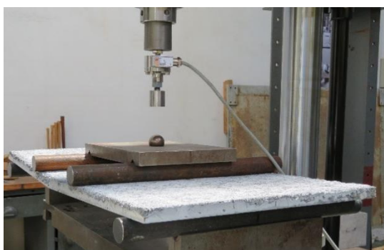
Obr. 122 Deska po zkoušce tahem za ohybu (66) Obr. 123 Pohled na desku po vyjmutí z lisu (66)
