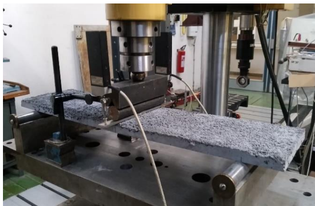
Obr. 133 Deska při zkoušce tahem za ohybu (66)
