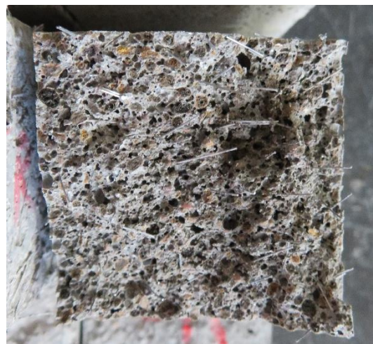
Obr. 126 Pohled na vnitřní strukturu trámce s výztuží (66)
