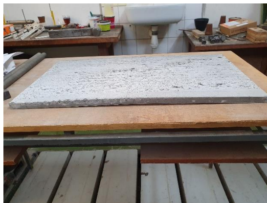
Obr. 85 Pohled na desku s redukovanou trvalou deformací po odtížení (66)
