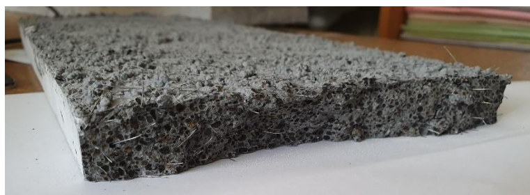
Obr. 136 Pohled na vnitřní strukturu rozlomené desky sady C (66)
