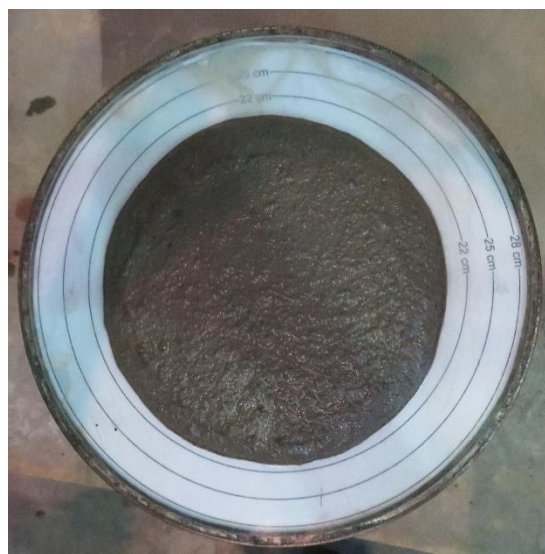
Obr. 48 Příklad konzistence receptury pro LWAFRC, bez rozptýlených ocelových vláken (66)
