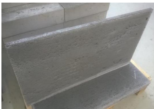
Obr. 87 Deska z vertikálního bednění s patrným rozvrstvením (59)
