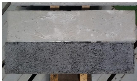
Obr. 137 Detail horního povrchu desky (66) Obr. 138 Pohled na horní povrch desky – nahoře s úpravou nabetonávkou, dole bez úpravy (66)
