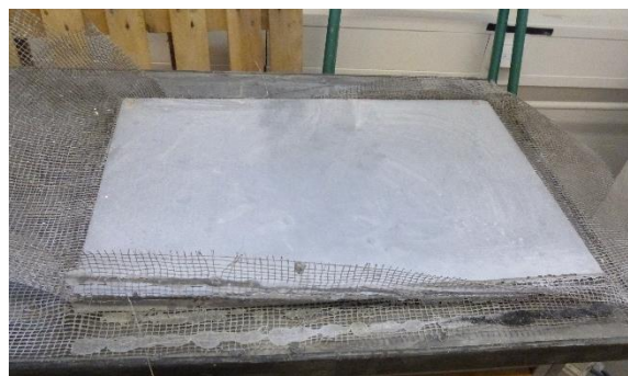
Obr. 58 Pohled na desku s čedičovou textilií po odbednění (66)
