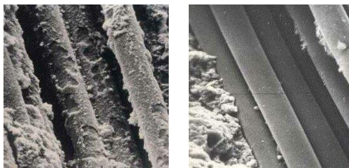
Obr. 12 Porovnání běžných (vlevo) a alkalivzdorných skleněných vláken (vpravo) po několika týdnech v betonové matici (33)
