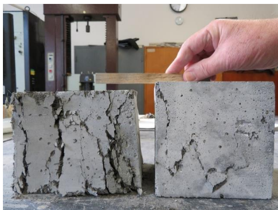
Obr. 113 Vyztužené krychle po zkoušce v tlaku (66)
