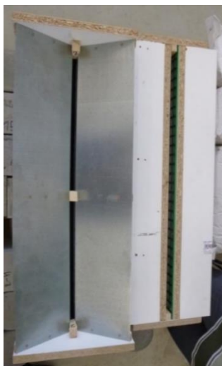
Obr. 64 Vertikální bednění s nálevkou (66)
