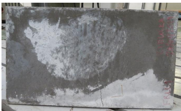
Obr. 127 Pohled na desku po vyjmutí z lisu (66) Obr. 128 Deska při zkoušce tahem za ohybu (66)
