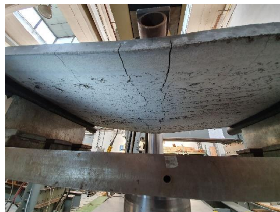
Obr. 83 Pohled na namáhaný povrch v okamžiku ukončení zkoušky (66)
