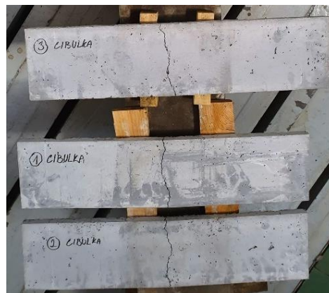
Obr. 134 Pohled na desky po vyjmutí ze zkušebního zařízení (66)
