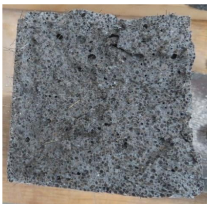
Obr. 112 Rozlomený vyztužený trámec (66)
