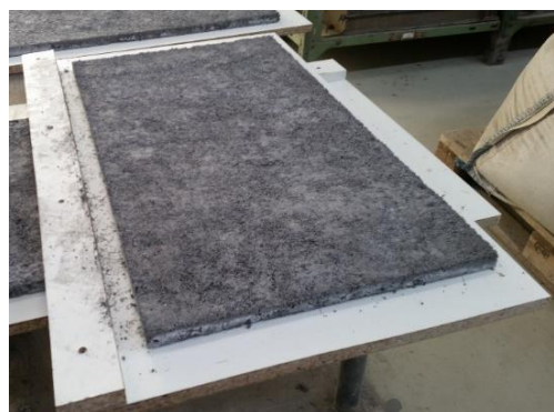
Obr. 117 Pohled desku při odbedňování (66)
