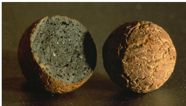
Obr. 1 Zrno Liaporu a jeho řez (3)
