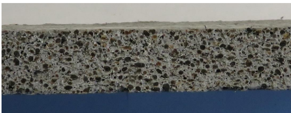
Obr. 132 Pohled na vnitřní strukturu rozříznuté desky sady B (66)
