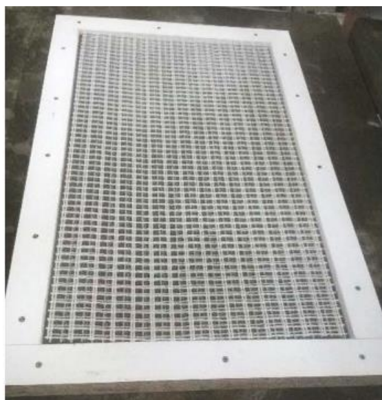
Obr. 77 Horizontální bednění s vloženou prostorovou skelnou textilií (59)
