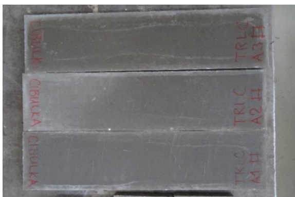
Obr. 96 Pohled na spodní strany odbedněných desek se sítí A (66)
