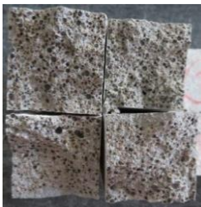
Obr. 105 Vnitřní struktura na lomech trámů (66)
