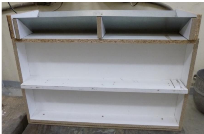
Obr. 65 Boční pohled na vertikální bednění pro desku s nálevkou a fixovanou uhlíkovou textilií (66)
