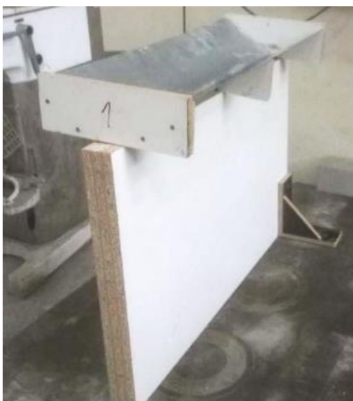
Obr. 76 Vertikální bednění s nálevkou (59)
