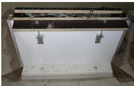
Obr. 57 Vertikální bednění s vypnutou čedičovou textilií (66)
