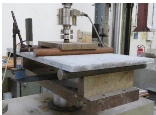
Obr. 127 Pohled na desku po vyjmutí z lisu (66) Obr. 128 Deska při zkoušce tahem za ohybu (66)
