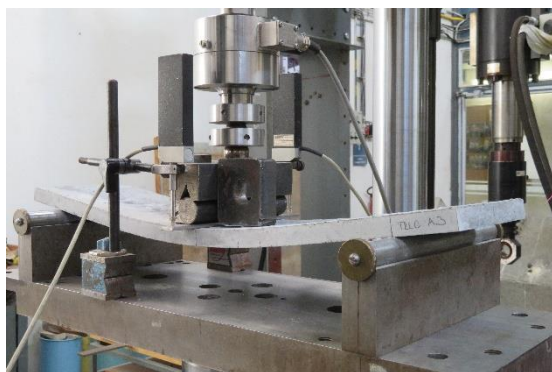
Obr. 99 Deska při zkoušce ohybem (66)
