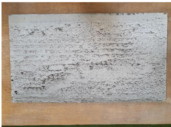
Obr. 84 Pohled na desku s téměř uzavřenými trhlinami po ukončení zkoušky ohybem (66)
