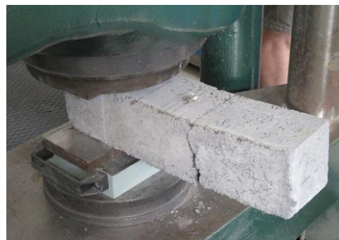
Obr. 121 Zkouška v tlaku na zbytcích trámců (66)
