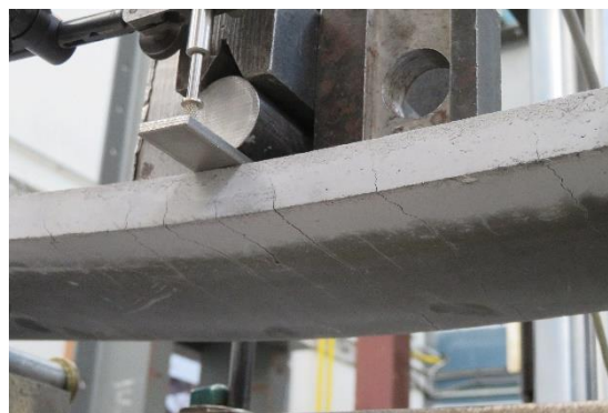
Obr. 100 Detail porušení desky při zkoušce ohybem (66)
