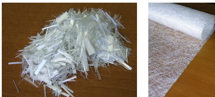
Obr. 13 Příklad skelných vláken v podobě sekaných pramenů (vlevo) a plošné výztuže z pramenů (33)
