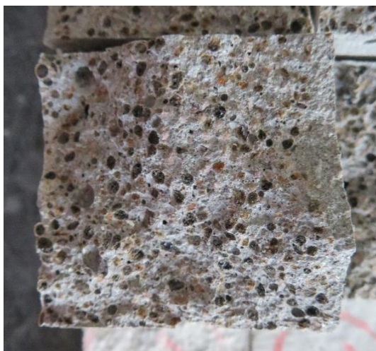
Obr. 125 Pohled na vnitřní strukturu trámce bez výztuže (66)
