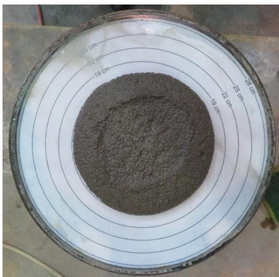
Obr. 47 Příklad konzistence vhodné do horizontálního bednění s vloženou prostorovou skelnou textilií (66)
