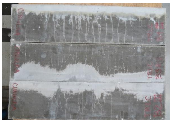
Obr. 102 Pohled na desky se sítí B s téměř uzavřenými trhlinami po zkouškách ohybem (66)
