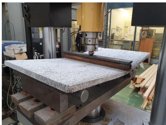
Obr. 82 Pohled na uspořádání zkoušky třibodovým ohybem (66)
