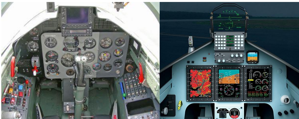
Obrázek 22: Srovnání avioniky v letounech L-39 (vlevo) a L-39NG (vpravo); zdroj [63][25]
