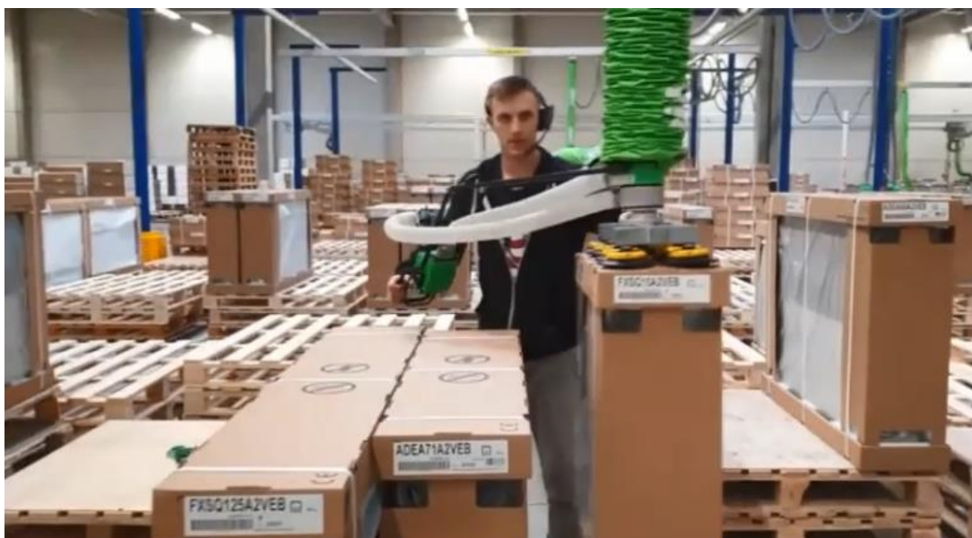
[8] Pracovník ovládající rameno v kombinaci s Pick by Voice technologií logistickém centru MOL Logistics v Plzni
