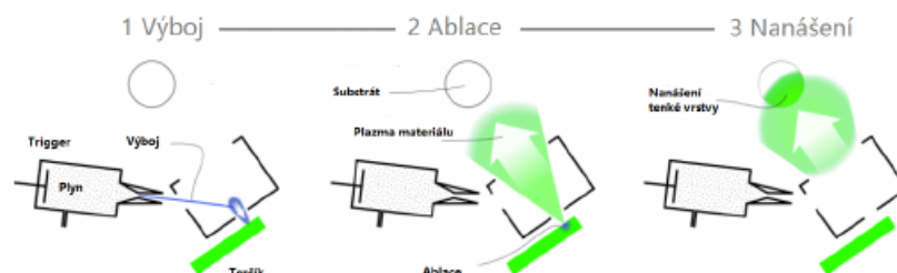
Obrázek 2.1: Schématické zobrazení průběhu nanášení tenkých vrstev metodou IJD.[32]
