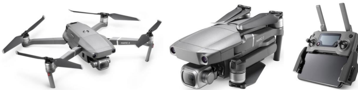
Obrázek 88: DJI Mavic 2 Pro – rozložený, složený a dálkové ovládání
