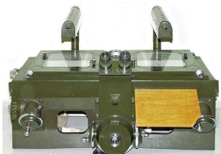
Obrázek 8: Ukázka fotogrammetrického přístroje pro vyhodnocení snímků – Stecometr 1818 15
