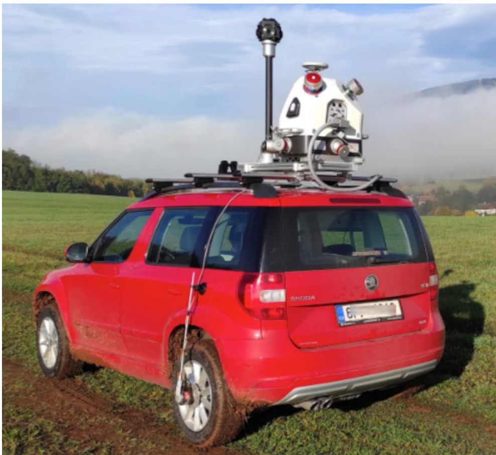
Obrázek 108: Konkrétní systém a vozidlo společnosti Geovap použité v rámci projektu Základní parametry použitých skenerů Riegl jsou uvedeny v následující tabulce.
