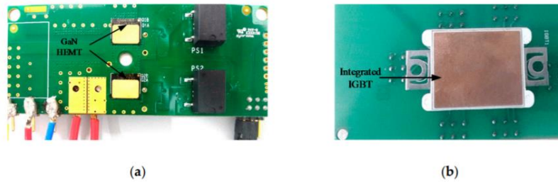
Obrázek 14 tranzistory (a) GaN HEMT – CS66516T, (b) IGBT – FS50R06W1E3 [14]
