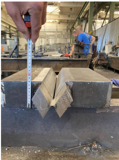
Obrázek číslo 31: Vzorek před svařením
