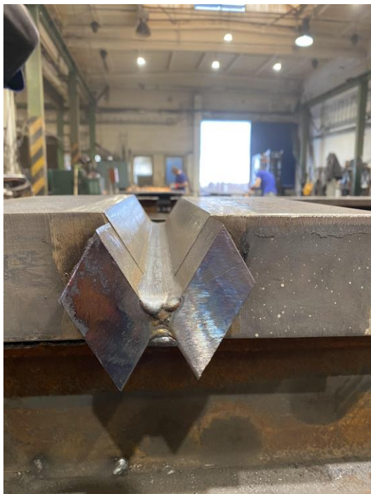
Obrázek číslo 34: Vzorek po aplikace 5. housenky
