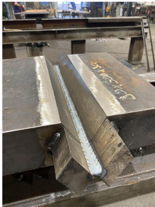
Obrázek číslo 35: Vzorek během procesu svařování
