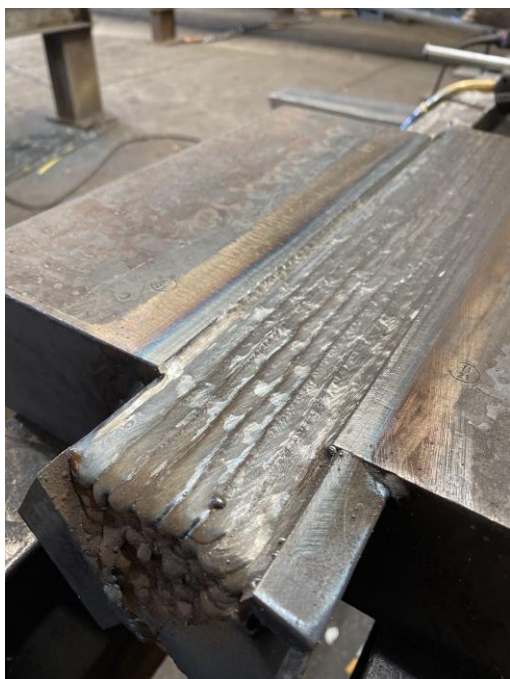
Obrázek číslo 36: Kompletně zavařený vzorek 1
