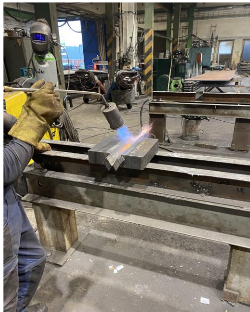
Obrázek číslo 32: Svářeč provádějící předehřev
