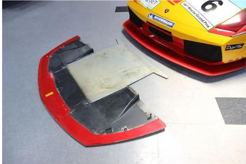
Obrázek 92 Ukázka splitteru na voze Lamborghini Gallardo GT3 2008 [30]
