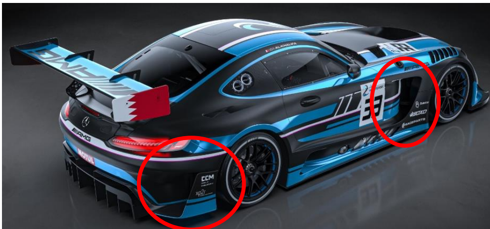
Obrázek 20 Ukázka bočních průduchů na závodním vozu Mercedes-AMG GT3 [16]
