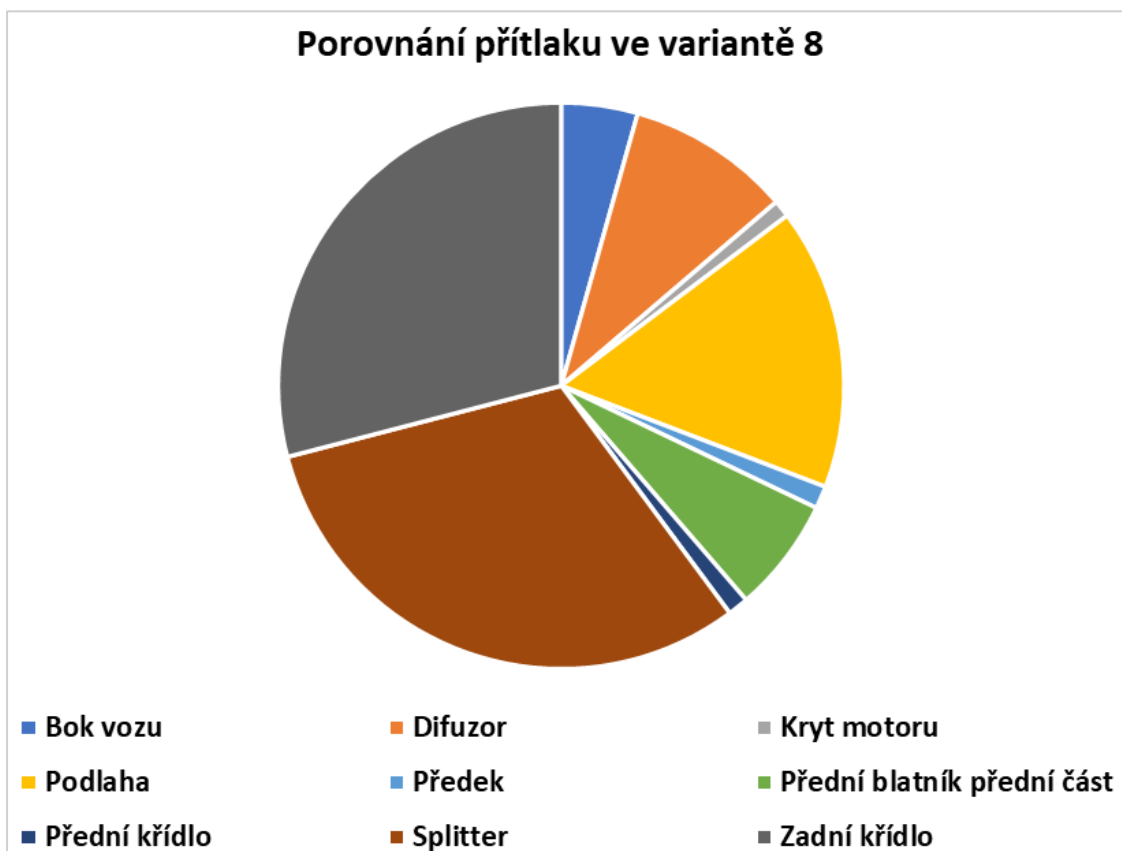
Obrázek 78 Porovnání přitlaku na jednotlivých komponentech varianty 8
