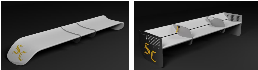
Obrázek 11 Ukázka konstrukce zadních křidel (vlevo jednoelementové, vpravo dvouelementové)
