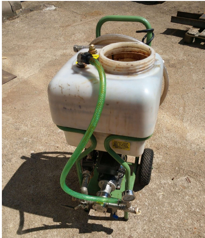
Obrázek 17 – Čerpadlo se sběrnou nádobou
