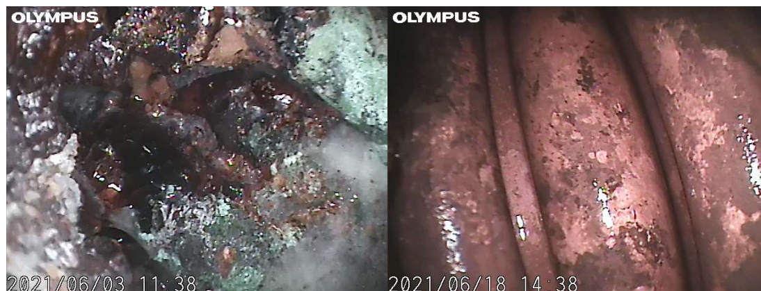
Obrázek 34 – Stav povrchu před a po vyčištění – sekundární okruh
