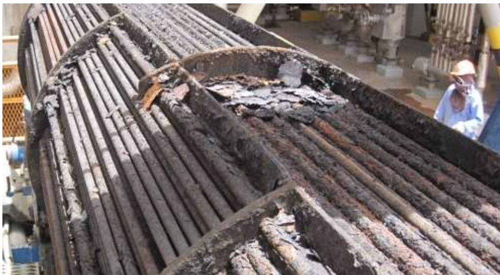
Obrázek 3 – Příklad krystalizačního zanášení [16]
