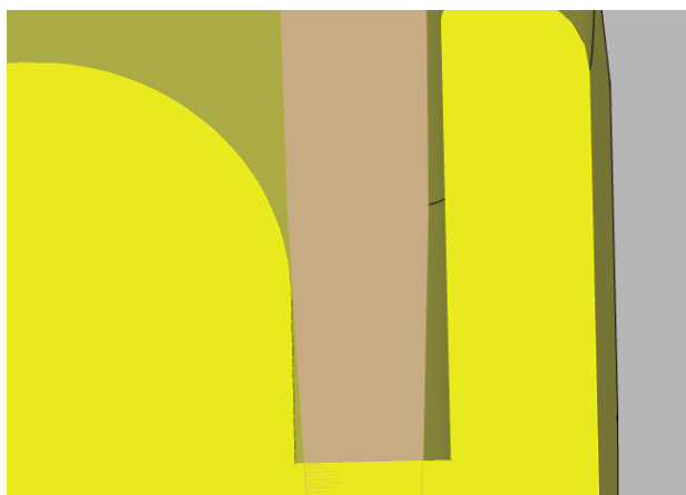
Obr. 40 Detail nevhodného kontaktu dílů
