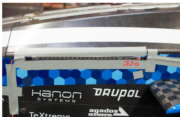
Obr. 73 Instalace tlakového pásku
