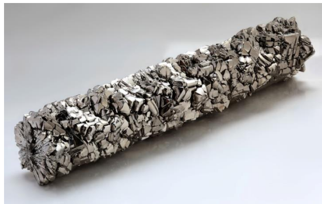
Obr.1 - Tyčinka z titanového krystalu [4]
