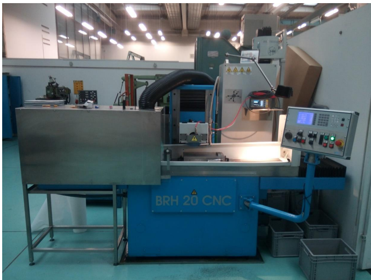
Obr. 9 – Bruska BRH 20 CNC v prostorech FS ČVUT
