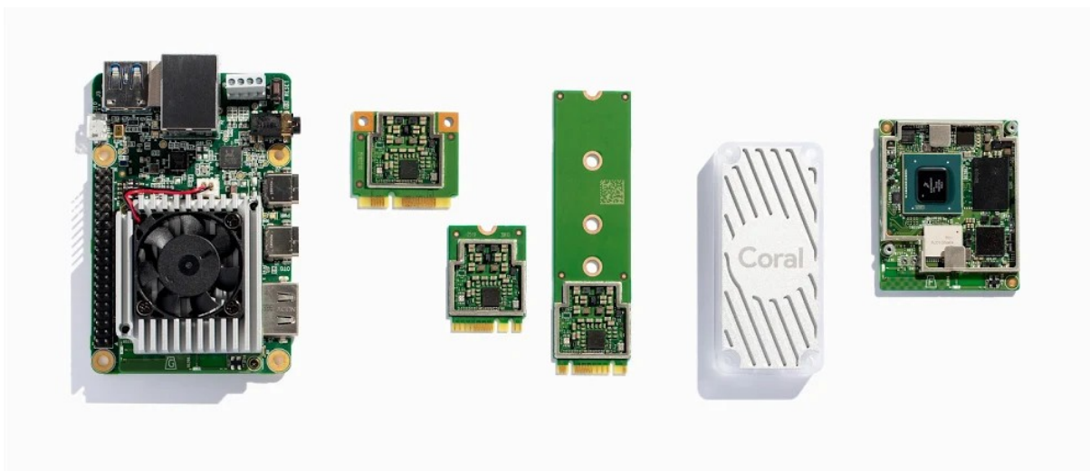
Obr. 9: Produkty Google Coral. Zleva – Vývojová deska osazená mikroprocesorem a TPU, Akcelerátory do M.2 slotu s čipem TPU, Externí USB-C akcelerátor s čipem TPU a System-on-module s mikroprocesorem a TPU.
