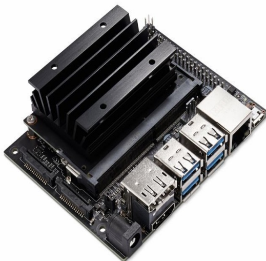
Obr. 8: Vývojová deska NVIDIA® Jetson NANO™ osazená mikroprocesorem a GPU
