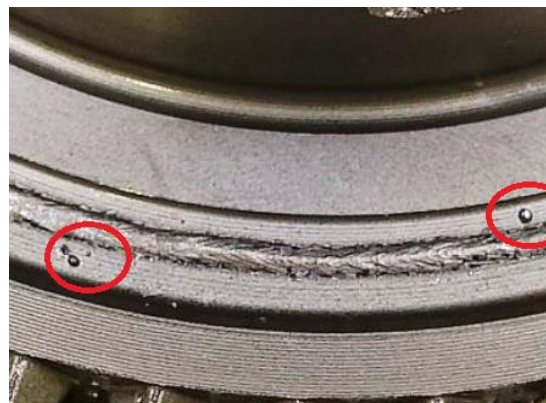
Obrázek 52 Rozstřík svarového kovu [1]
