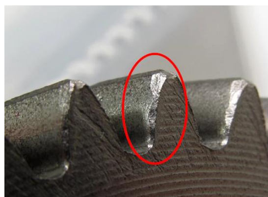
Obrázek 54 Špatně provedený keeping 2 [1]
