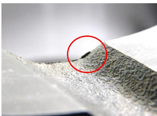
Obrázek 53 Ořep v mazací drážce [1]
