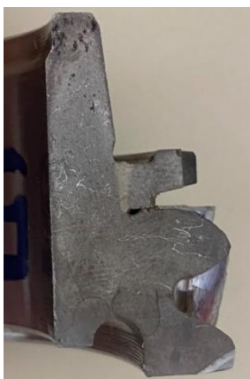
Obrázek 83 Vzorek s viditelností průvaru svaru
