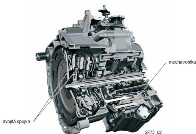
Obrázek 8 Hlavní části převodovky DQ 200 [3]
