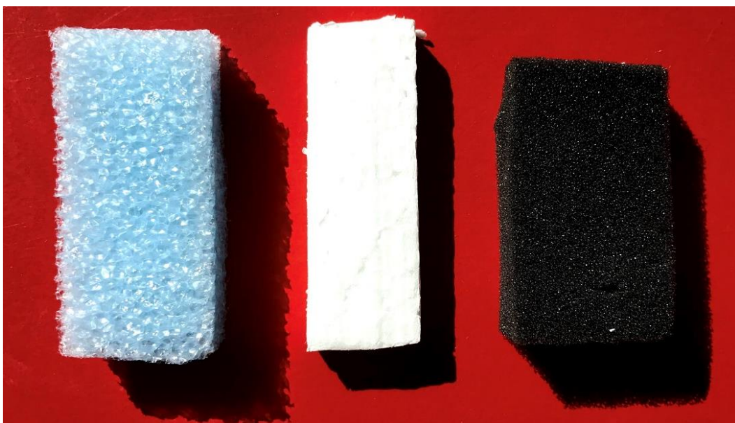
Obrázek 18 - testované materiály pro zhotovení kontaktní plochy (zleva: pěnový polyethylen, pěnový polystyren, molitan)
