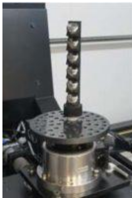
Obrázek 7 - přípravek pro snímání více součástí najednou vyrobený metodou 3D tisku [10]
