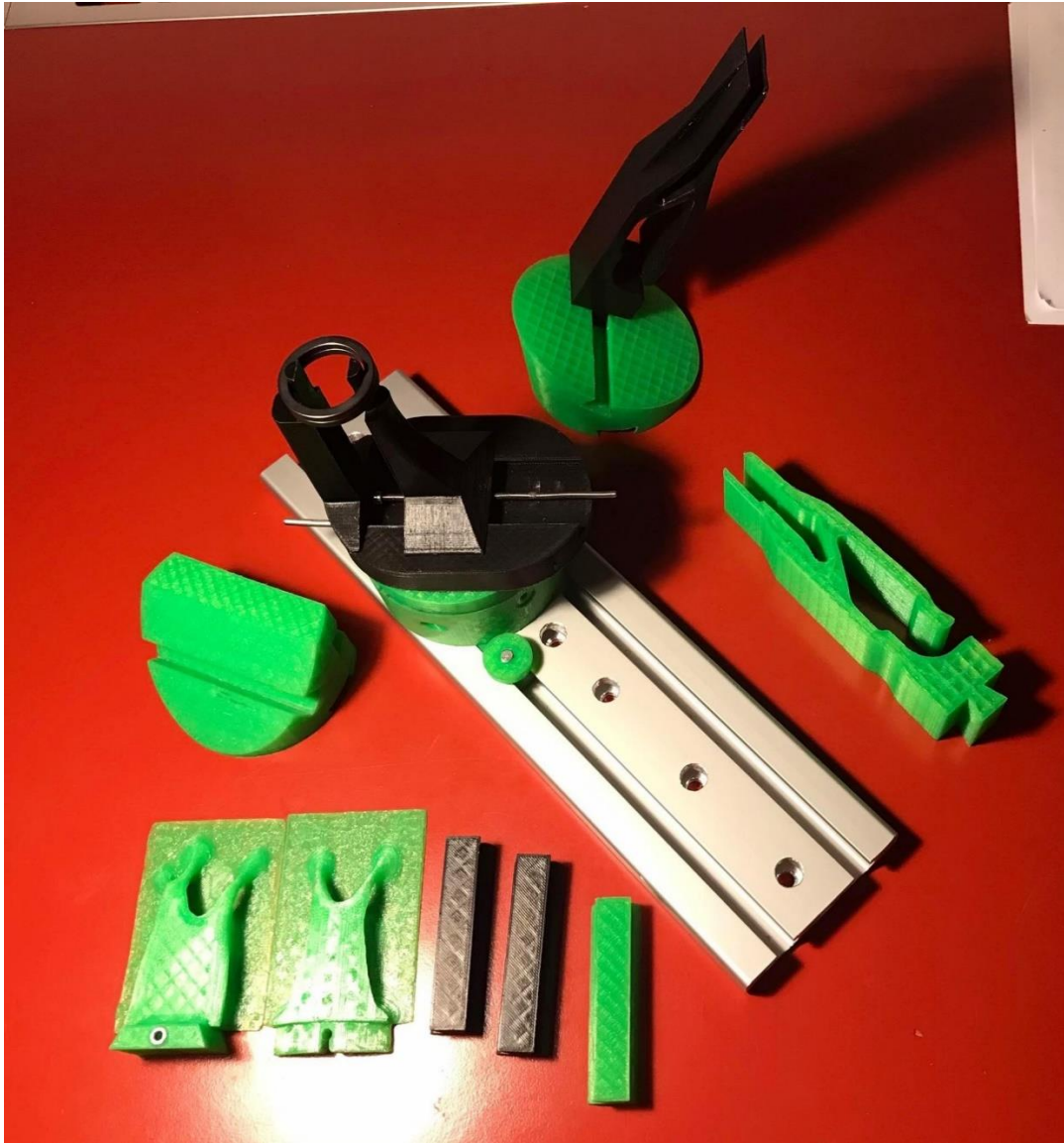
Obrázek 17 - hotový prototyp modulárního upínacího systému + některého příslušenství
