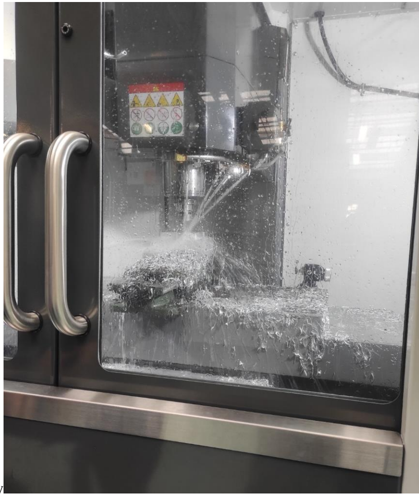
Obrázek 46: Obrábění na CNC frézce HAAS VF-2
