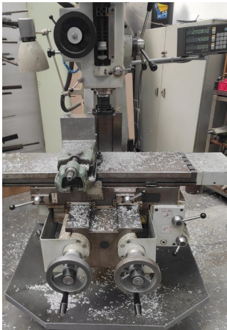
Obrázek 44: Konvenční frézka s upnutým polotovarem
