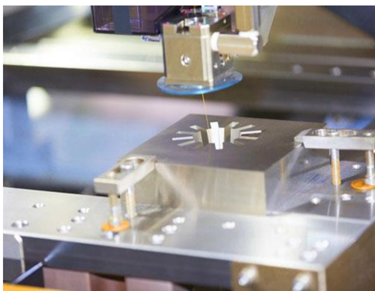
Obrázek 16: Ukázka řezání drátovou elektrodou [31]
