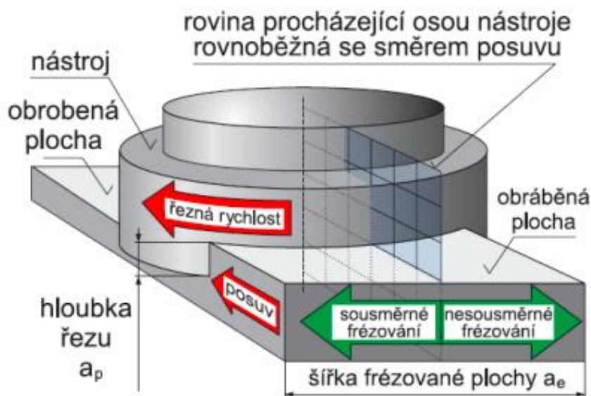
Obrázek 6 - Schéma čelního frézování [9]
