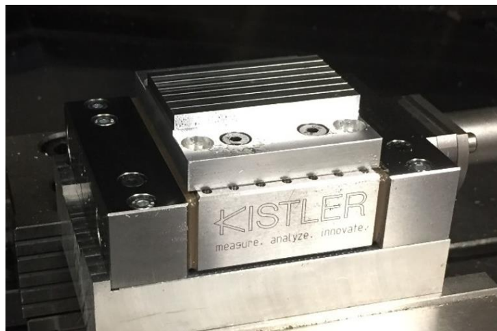
Obrázek 30 - Finální podoba obrobku upnutá na dynamometru KISTLER
