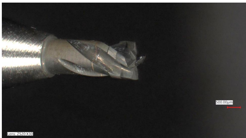
Obrázek 28 - Jedna z testovaných PKD fréz malého průměru
