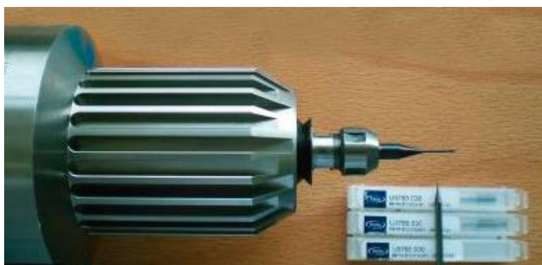
Obrázek 8 - Mikrofréza v upínáči [18]
