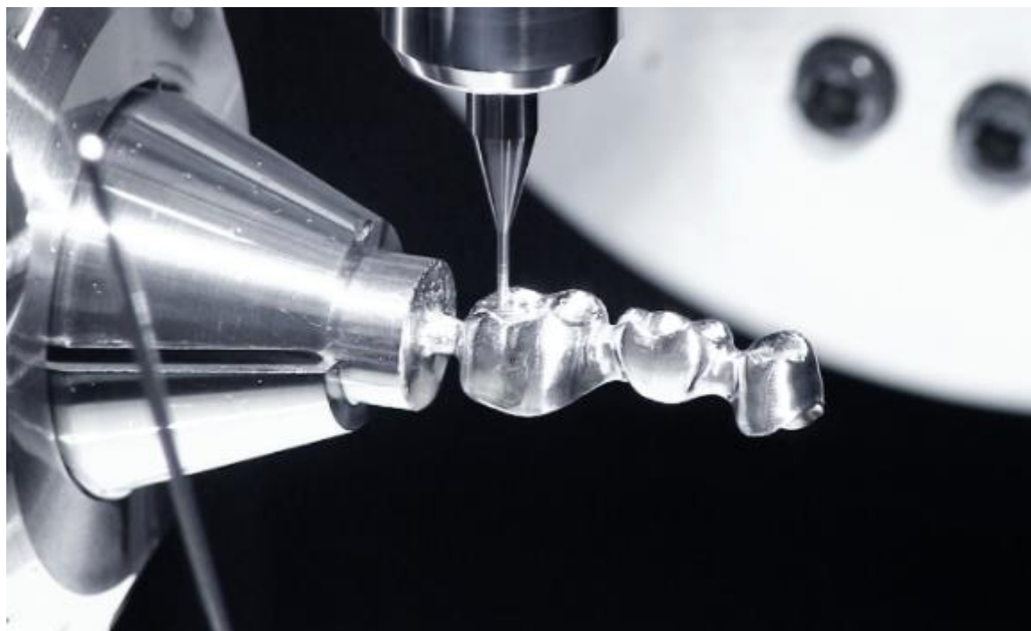
Obrázek 22 - Výroba zubní náhrady mikrofrézováním [35]
