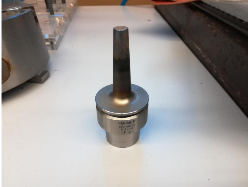
Obrázek 29 - Tepelný upínač HAIMER
