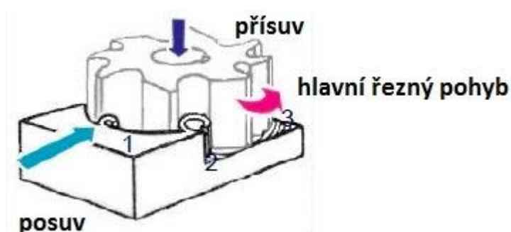
Obrázek 3 - Řezné pohyby při čelním frézování [39]
