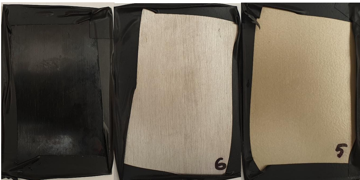
Obrázek 19 Výsledek experimentu v kondenzační komoře (1000 hodin)
