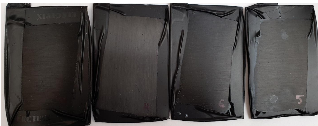
Obrázek 20 Výsledek experimentu v solní lázně po 672 hodinách, černá anodická oxidace
