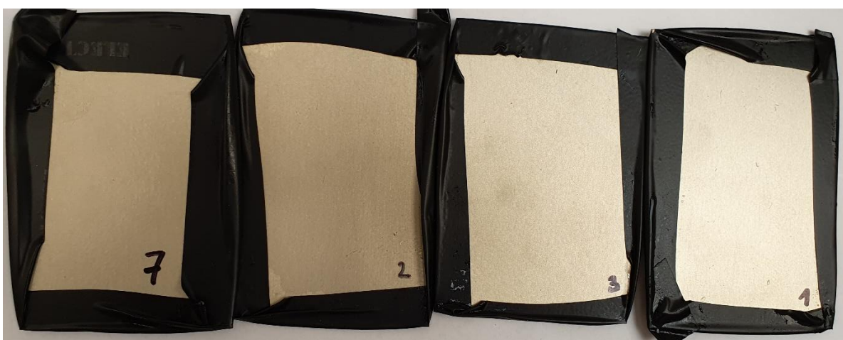
Obrázek 22 Výsledek experimentu v solní lázni po 672 hodinách, prášková barva
