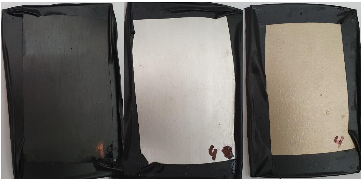
Obrázek 17 Výsledek experimentu v kondenzační komoře (240 hodin)
