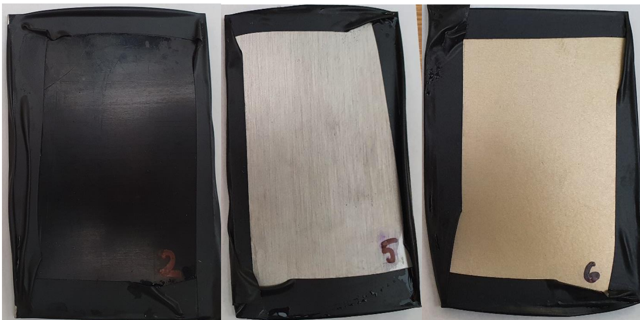
Obrázek 18 Výsledek experimentu v kondenzační komoře (720 hodin)
