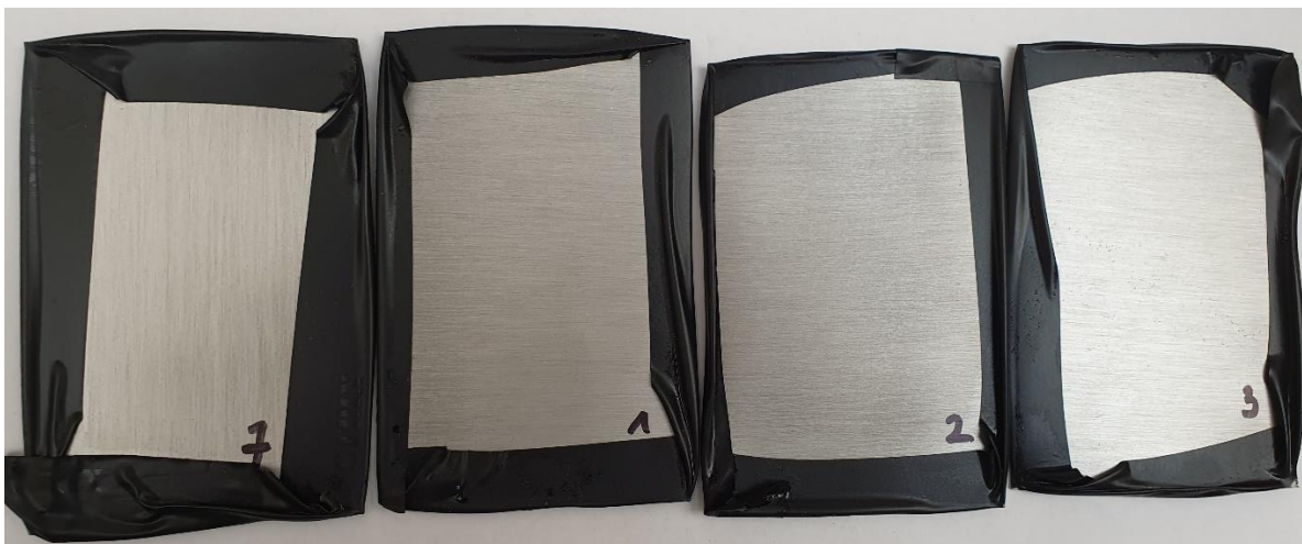
Obrázek 21 Výsledek experimentu v solní lázni po 672 hodinách, stříbrná anodická oxidace
