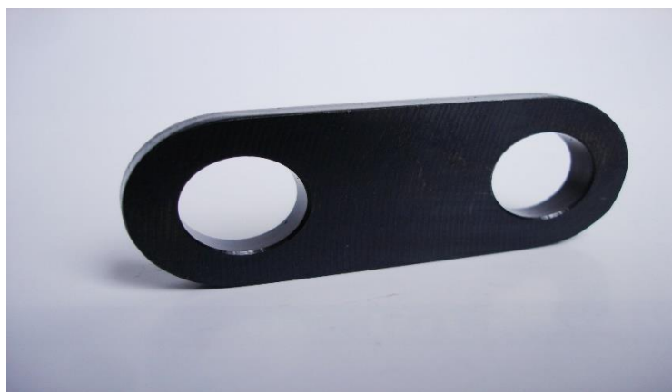
Obrázek 4 Ukázka tvrdé anodické oxidací [26]
