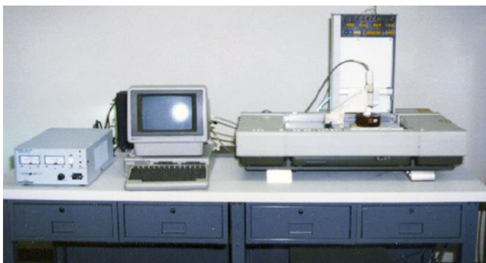
Obr. 4 Tiskárna SLA-1 z roku 1988 [7]
