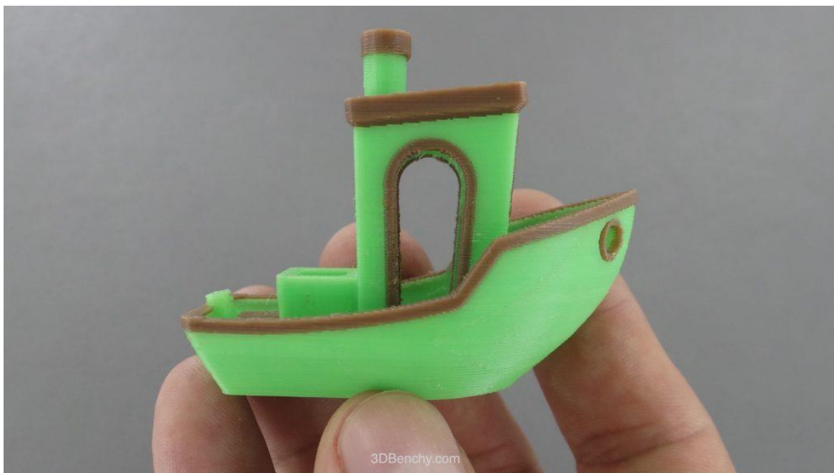
Obr. 21 Zkušební artefakt 3DBenchy [36]
