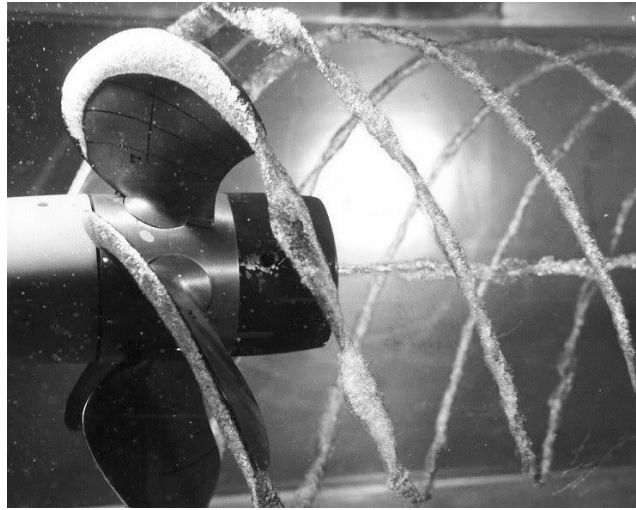
Obr.4: Kavitační dutiny při pohybu lodního šroubu [13]
