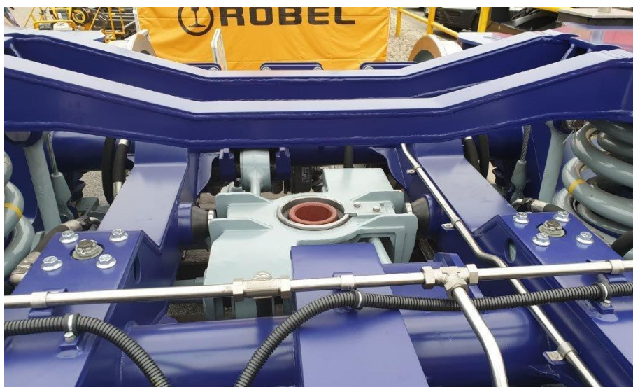
Obr. 14: Lemniskátový mechanismus (Z-mechanismus) podvozku 25ANa6 [12]
