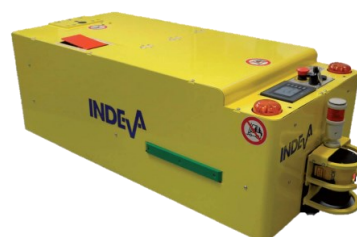
Obrázek 61 Podbíhací typ AGV s naloženým roltejnem [43]
