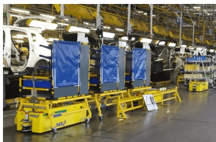
Obrázek 61 Podbíhací typ AGV s naloženým roltejnem [43]
