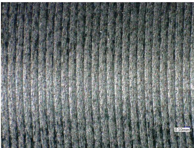
Obrázek 111 Ocel \varnothing 15 mm, f = 0.15 mm/ot, zvětšení 100x
