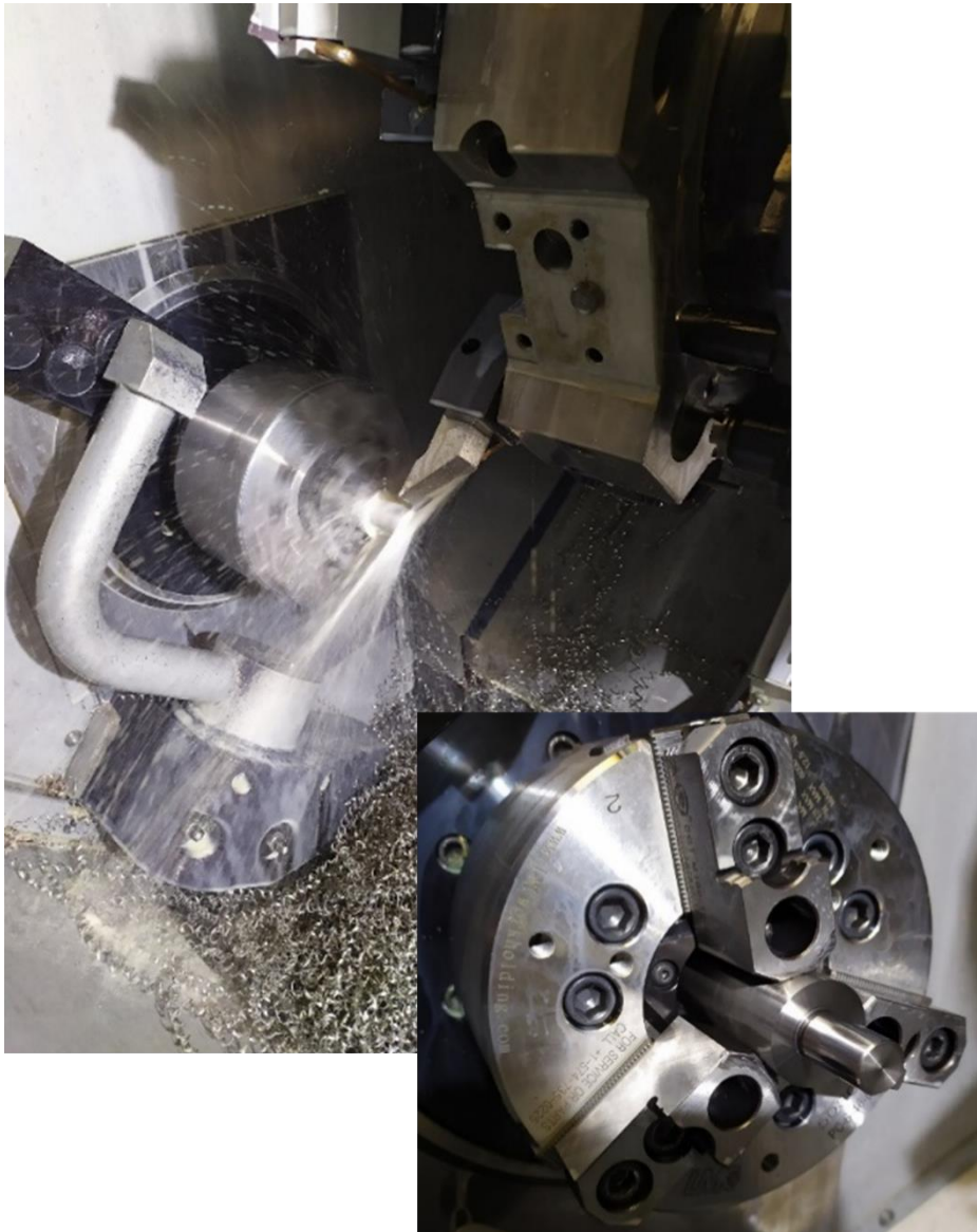
Obrázek 107 Obrábění zkušebního vzorku, ocel \varnothing 15 mm
