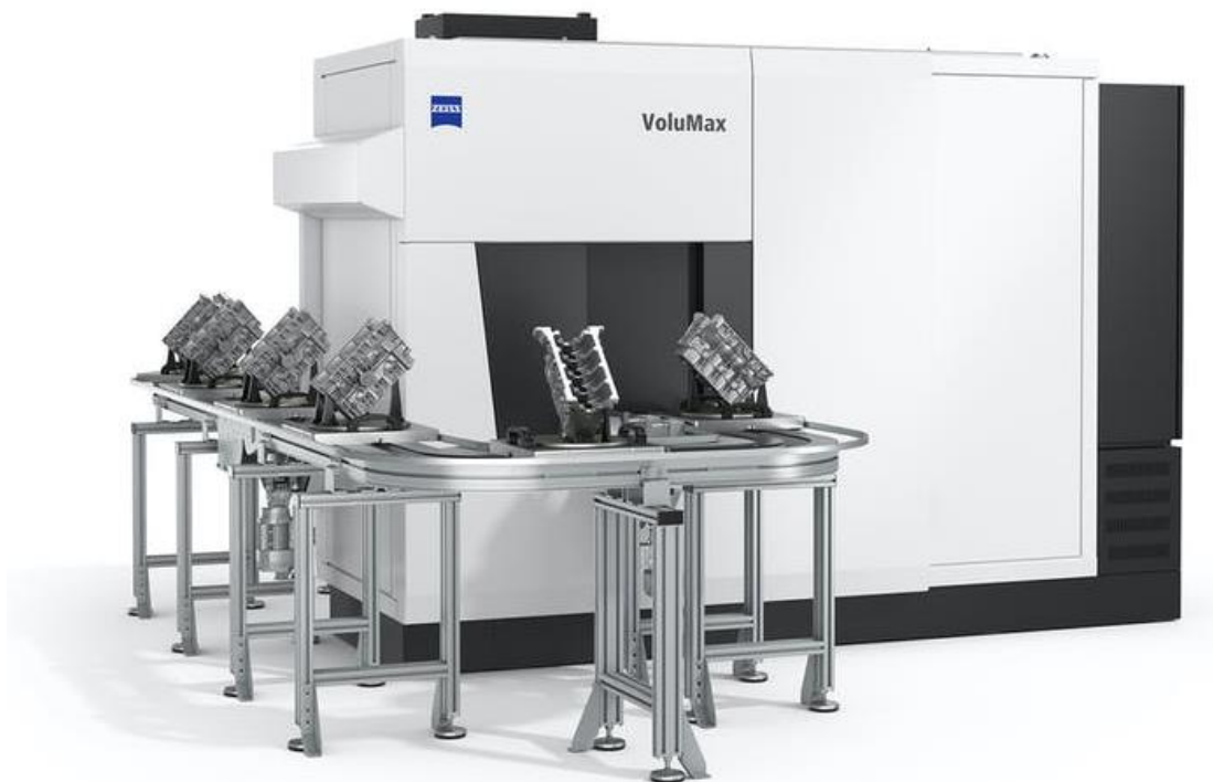
Obrázek 50 Volumax 1500, kontrola odlitků, integrace do automatické linky [34]
