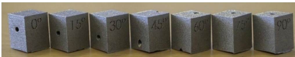
Obrázek 79 Vzorky 17-4 PH s chladicími kanálky ( \alpha = 0 - 90^\circ ) [45]
