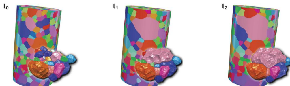
Obrázek 55 4D mapa vzorku (zrna železa), při žihání v jednotlivých časech [36]
