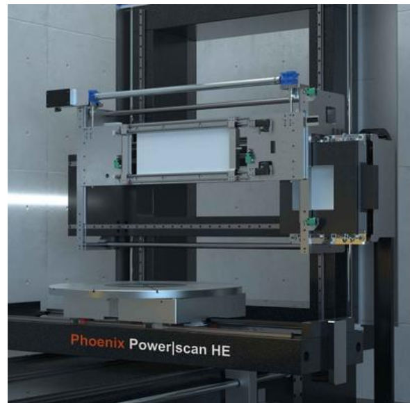
Obrázek 57 Lineární a plochý detektor [37]
