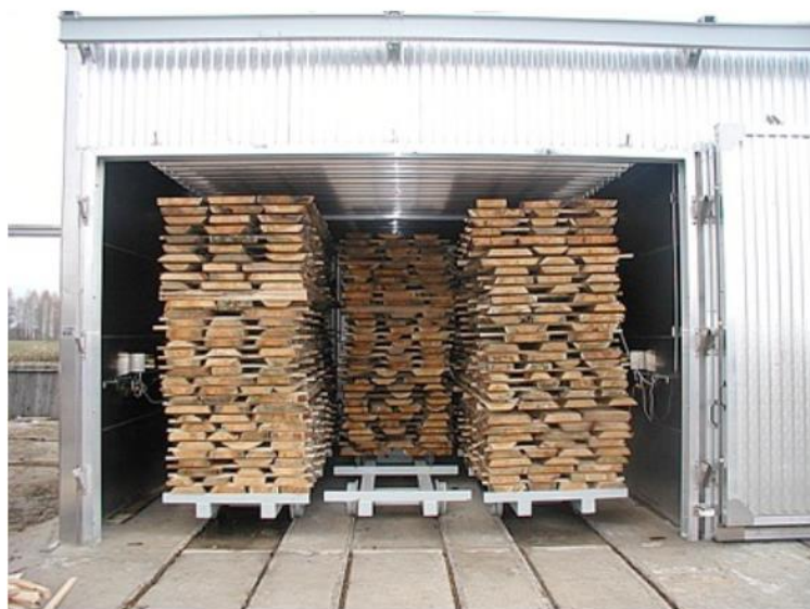
Obrázek 27. Ukázka komorového sušení dřeva [23]
