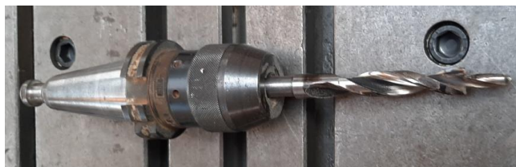
Obrázek 51. Vícefazetový stupňovitý vrták DIN8378 HSS 180° M8
