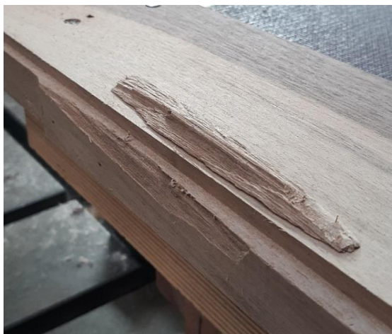
Obrázek 54. Vliv nesousledného směru obrábění
