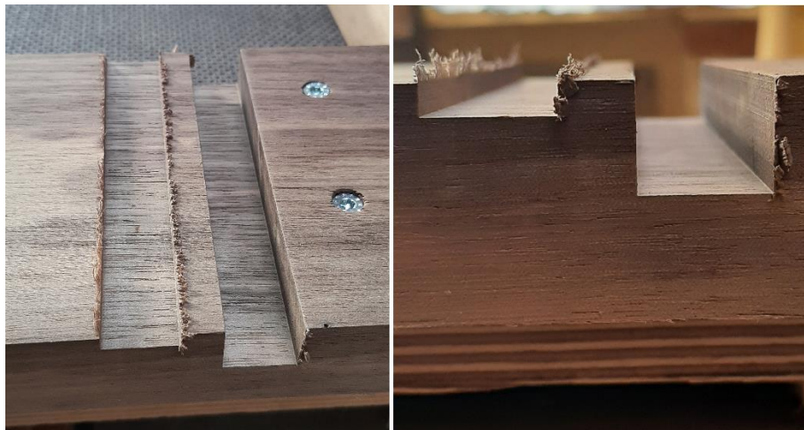
Obrázek 53. Vliv nakloněných břitů
