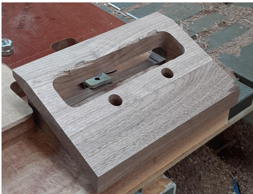
Obrázek 84. Upravené druhé hrubování s dokončením bočních ploch na čisto
