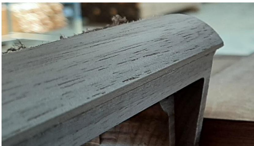
Obrázek 87. Opravená čistá hrana
