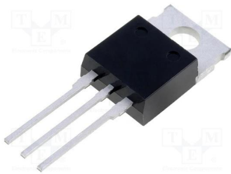
Obrázek 4: Tranzistor MOSFEET Zdroj: https://www.tme.eu
