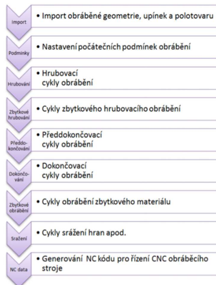
(5) Obecný postup při tvorbě pracovního postupu v CAD/CAM systému [7]
