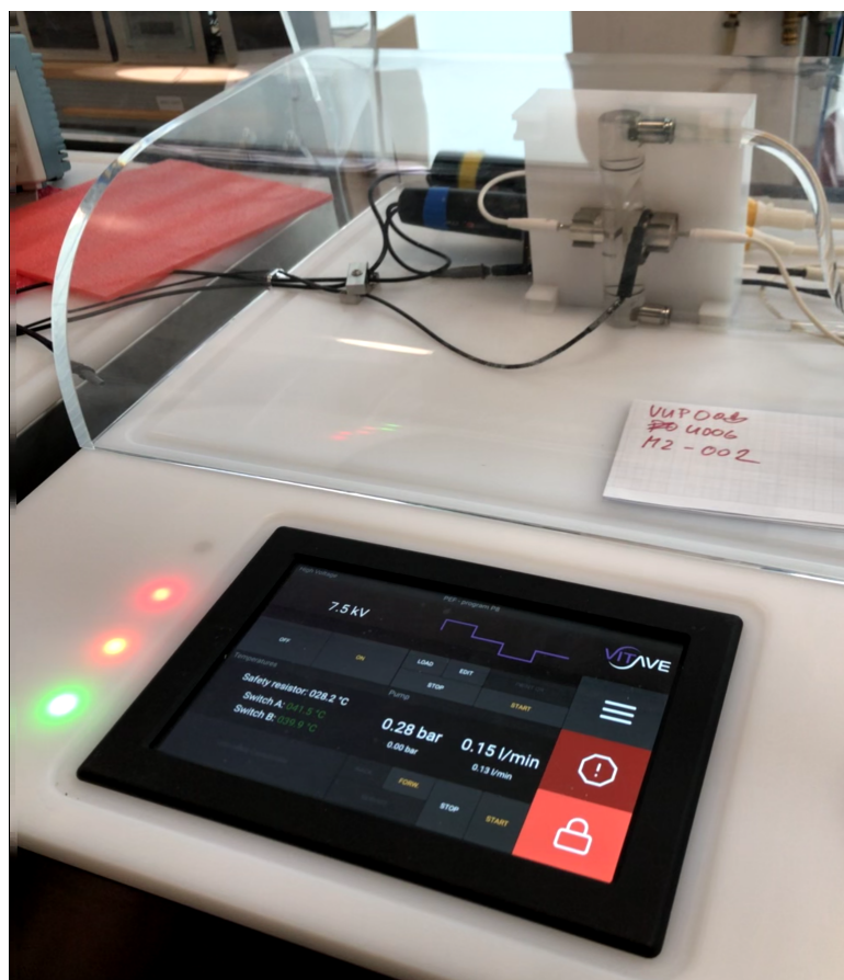
Obr. 4.9 Ostré testování automatizace řízení pro nastavené 150ml/min při výbojích 7.5 kV v komoře
