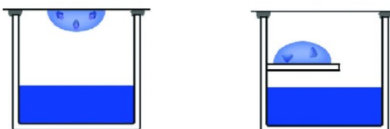
Obrázek 1.2: Konfigurace pro metodu difuze par. Vlevo: visící kapka na sklíčku nad rezervoárem. Vpravo: sedící kapka na můstku nad hladinou rezervoáru. Kapka vznikla smísením proteinu a mateřského roztoku z rezervoáru (tmavě modře). [3]
