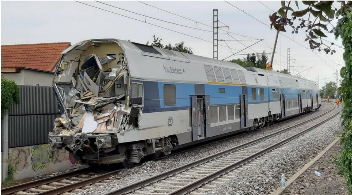
Obrázek 8: Souprava po srážce s nákladním automobilem, který po nerespektování výstrahy zůstal stát na přejezdu se čtyřdílnými závorami [21]
