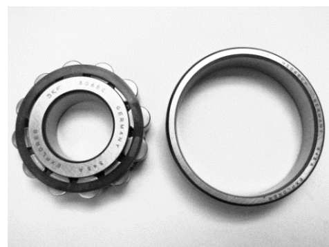
Obrázek 20: Rozložené testované válečkové ložisko N306, převzato z [17]
