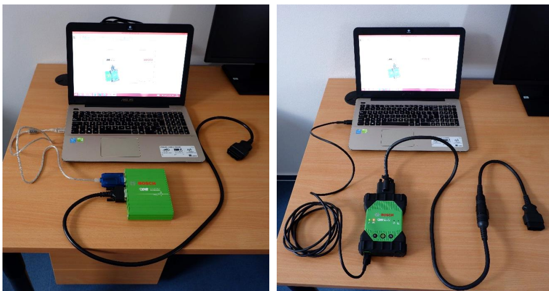
Obr. 18: Systémové zapojení při vyčítání přes DLC – modul CANplus (vlevo), modul CDR 900 (vpravo)
