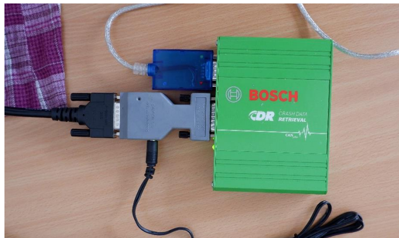
Obr. 33: Připojení zdroje napájení do portu adaptéru ACM
