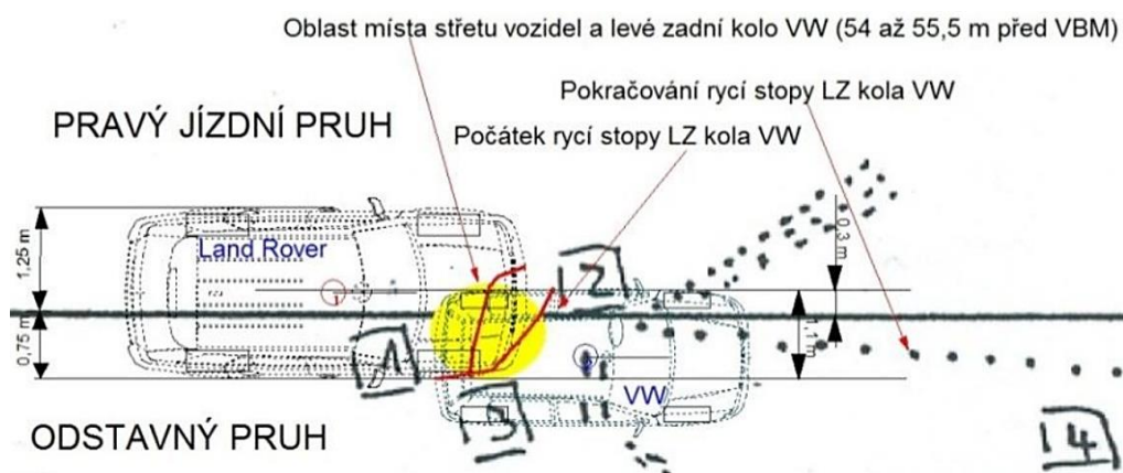
Obr. 2: Stanovení střetové polohy na základě zdokumentovaných stop [4]
