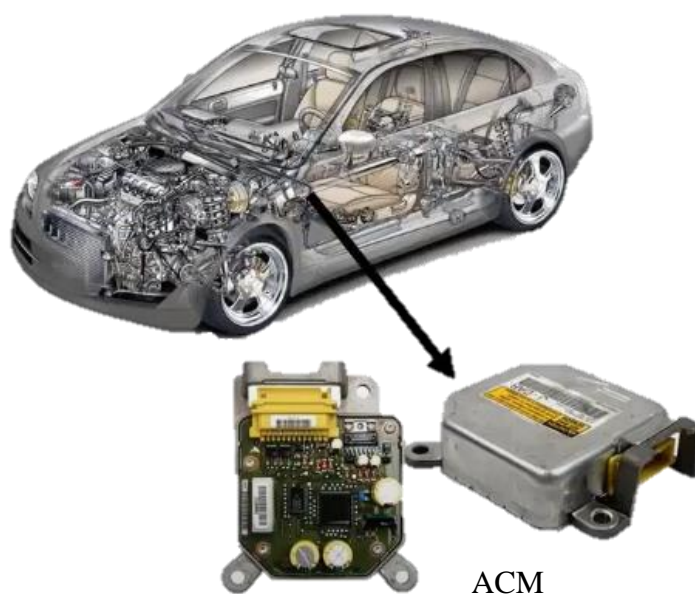
Obr. 10: Umístění modulu ACM ve vozidle (zdroj: https://www.crashdatagroup.com/ )
