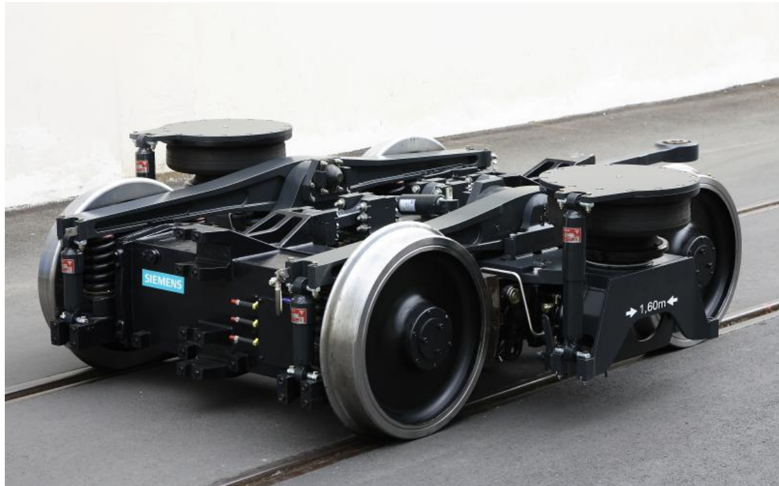
Obr. 27: Fotografie podvozku Syntegra (SIEMENS) [12]
