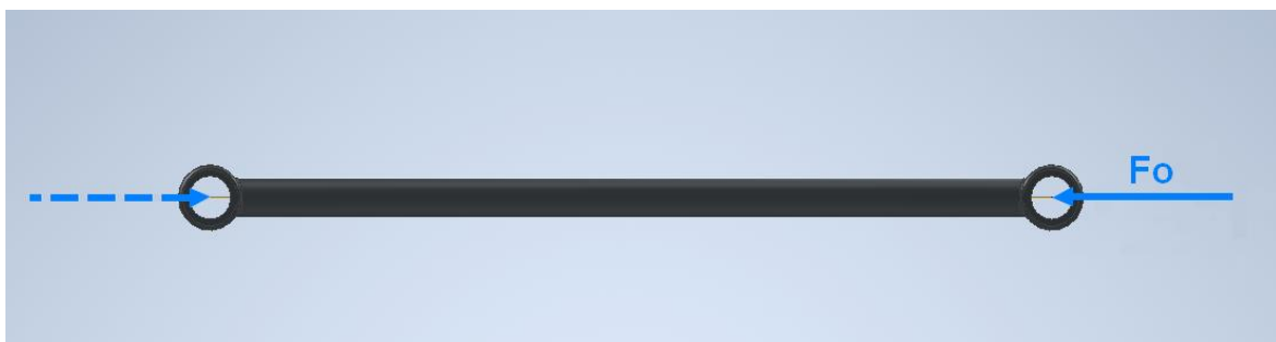
Obr. 31: 3D model tažně – tlačné tyče namáhané při přenosu sil jen na vzpěr/tah
