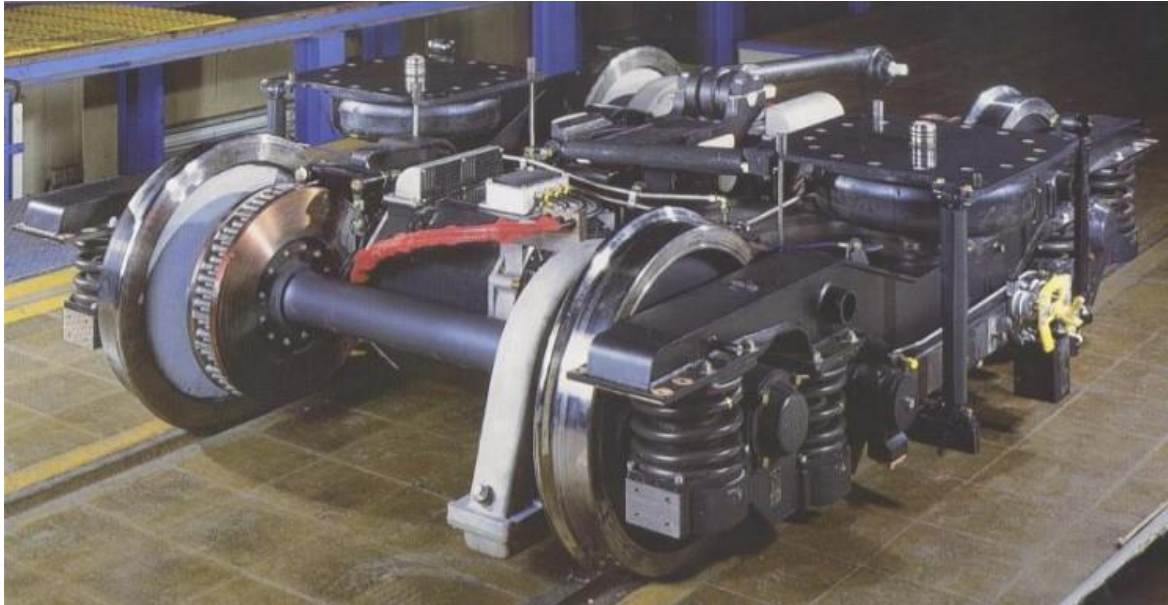
Obr. 21: Fotografie podvozku jednotky metra M1 [6]
