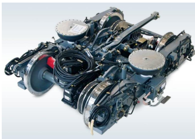
Obr. 29: Podvozek pro vozidla těžkého metra SF 1000 (Siemens) [14]
