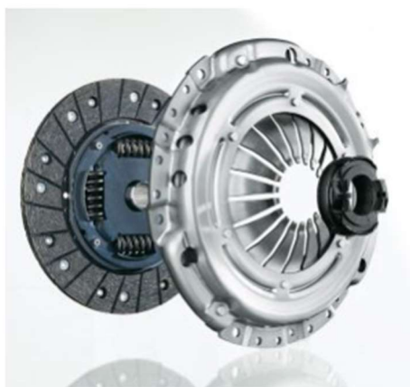
Obr. 15 - Lamela třecí spojky, štit s talířovou pružinou a ovládacím ložiskem [22]
