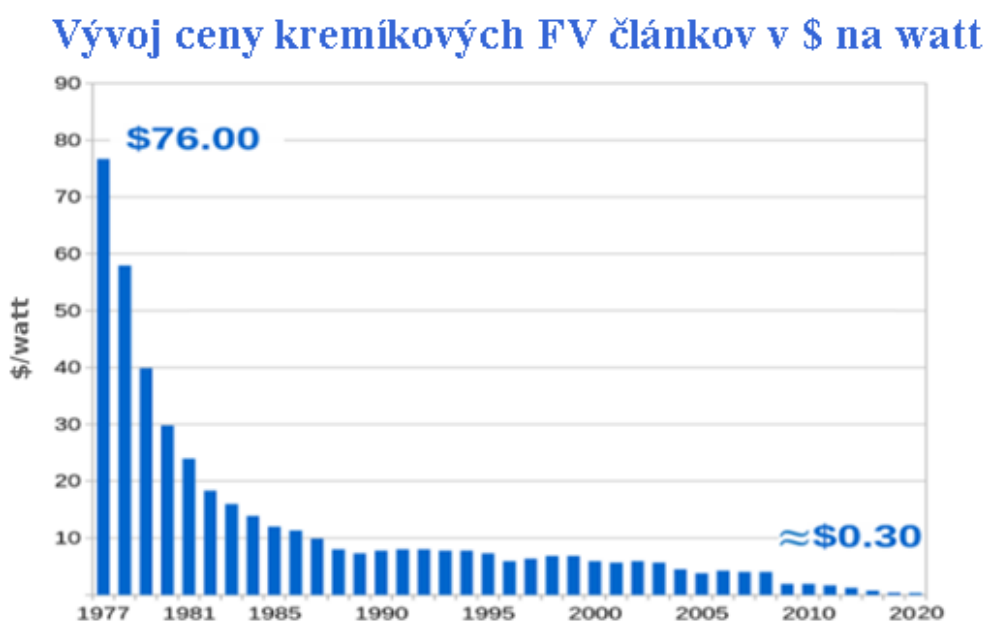
Obr. 1.1: Historický vývoj ceny kremíkových FV (fotovoltaických) článkov od roku 1977 v amerických dolároch na watt. [1]
