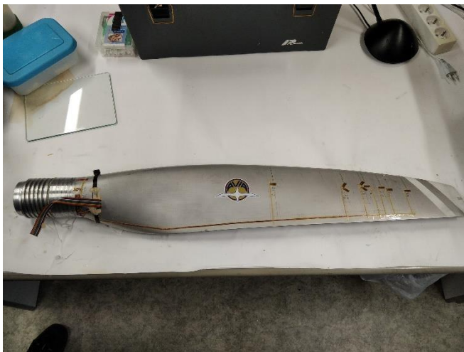
Obrázek 10: Vrtulový list s nalepenými tenzometry
