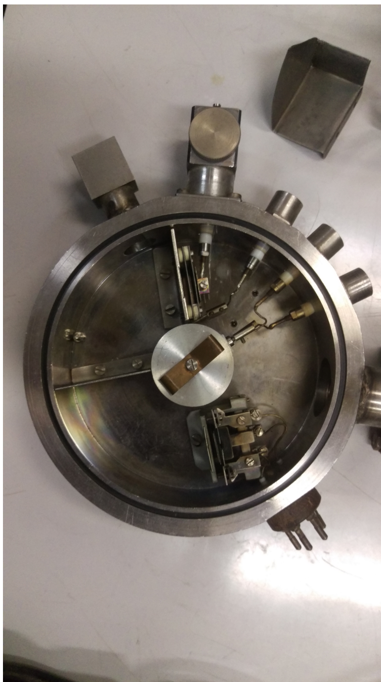
Obrázek 1.8: Na obrázku je zobrazen rozdělaný hmotnostní analyzátor využívající k separaci iontů magnetického pole.
