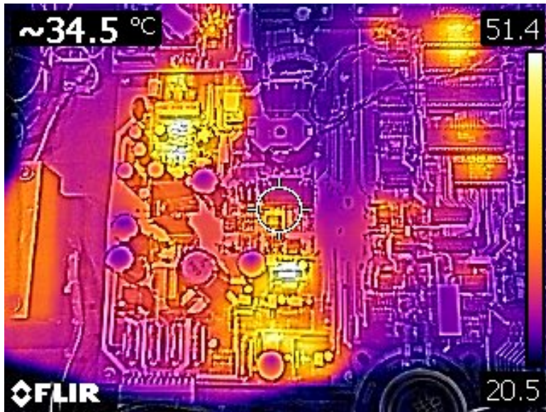
Obrázek 2.3: Snímek rozebrané řídicí jednotky termokamerou.
