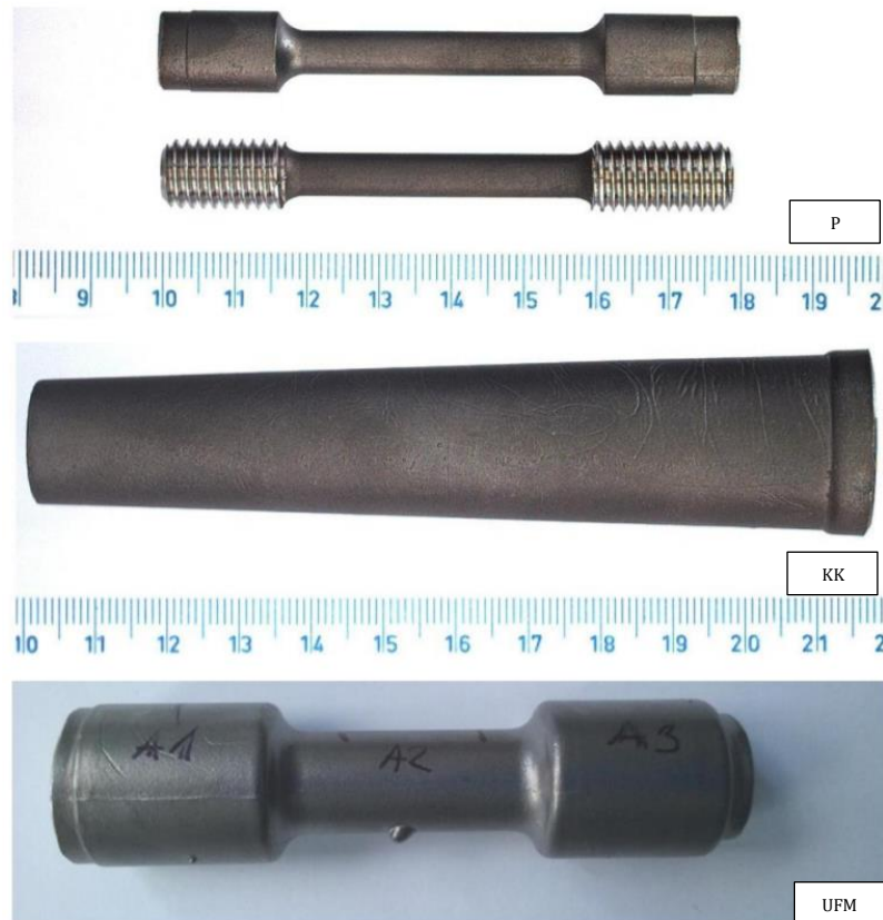
Obr.30: Snímek odlitku předlitých tahových zkoušek a z něj vyrobeného zkušebního tělesa (nahore). Pro porovnání jsou uvedeny i odlitky typu komolý kužel (ve středu) dále označovaný jako KK a činka (dole) dále označovaný jako UFM)
