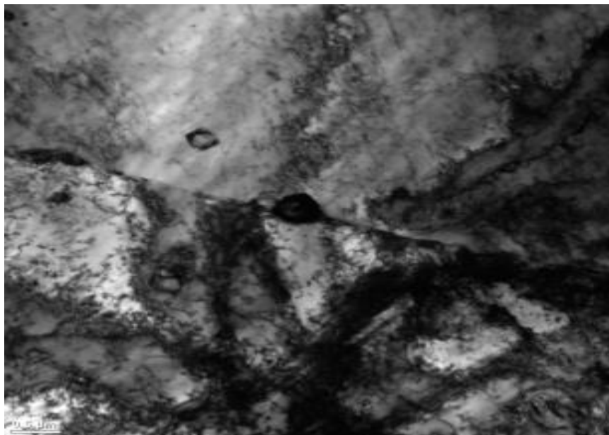
Obr. 9: Precipitát Z fáze na hranici zrn v SUPER 304H [8]
