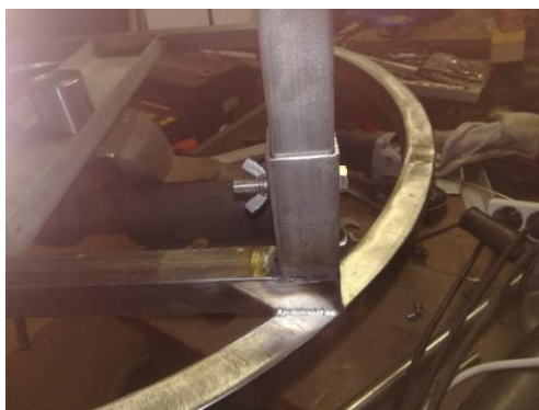
Obrázek 31 Šroubové spojení nohy podstavy
