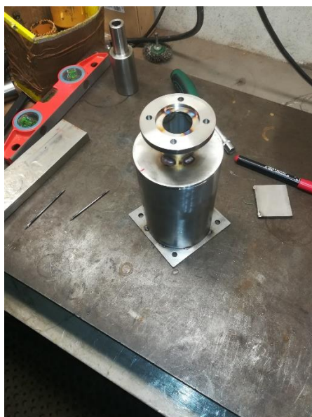
Obrázek 41 Spojková skříň po bodování
