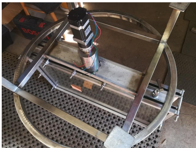
Obrázek 42 Spojení elektromotoru se skříní a spojkou
