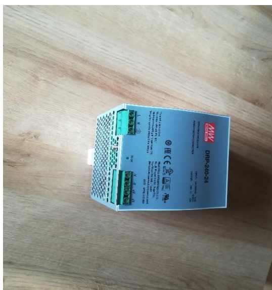
Obrázek 56 Zdroj MEANWELL DRP-240-24
