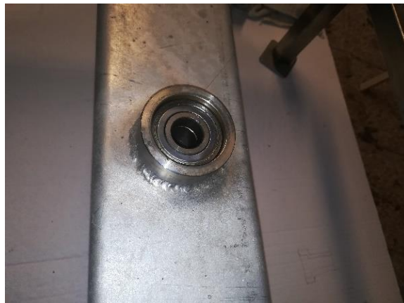
Obrázek 21 Ložisko v ložiskovém domku
