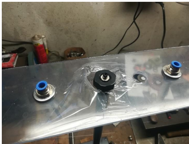
Obrázek 50 Instalace fluorescenční sondy 1
