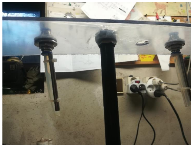
Obrázek 51 Instalace fluorescenční sondy 2
