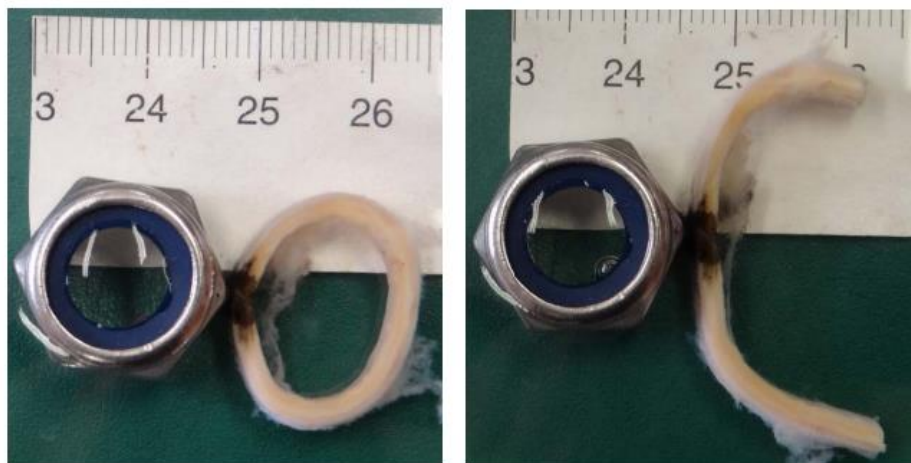
Obrázek 8 – Samovolné rozevření tepenného kroužku po rozstřížení [47]
