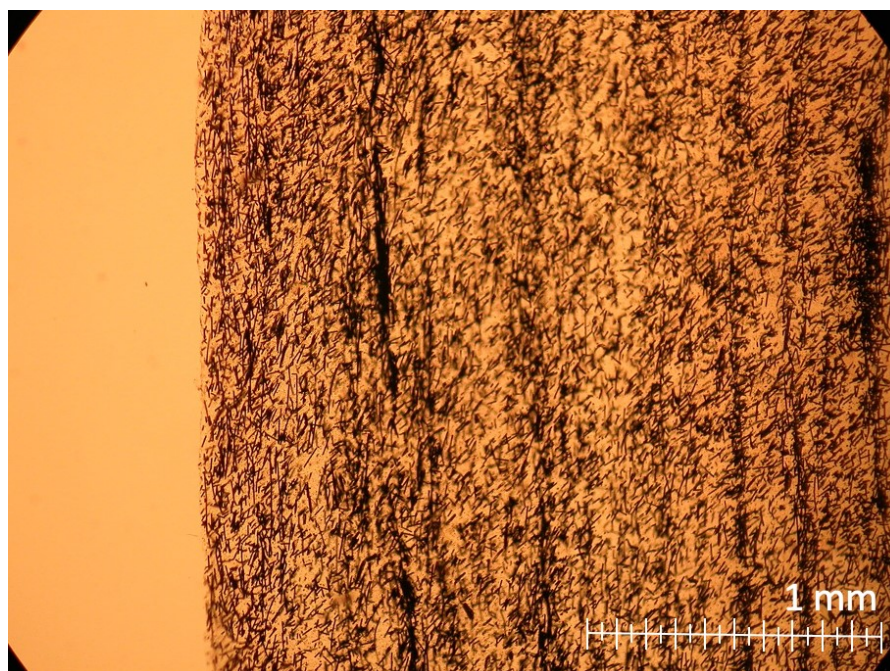
Obrázek 43 Částečné uspořádání vláken u vzorku PE-CF10
