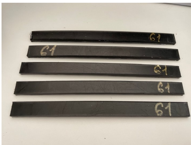
Obrázek 39 Příklad vzorků pro tahovou zkoušku z PEp-5CF
