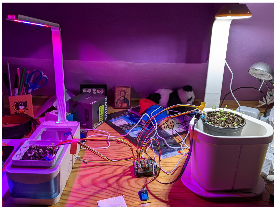
■ Obrázek 3.1 Měřící zařízení mezi dvěma testovanými vzorky. Na stole si můžeme kromě ohromného nepořádku všimnout přilepeného senzoru teploty a vlhkosti vzduchu, v každém květináči pak dalších senzorů.
