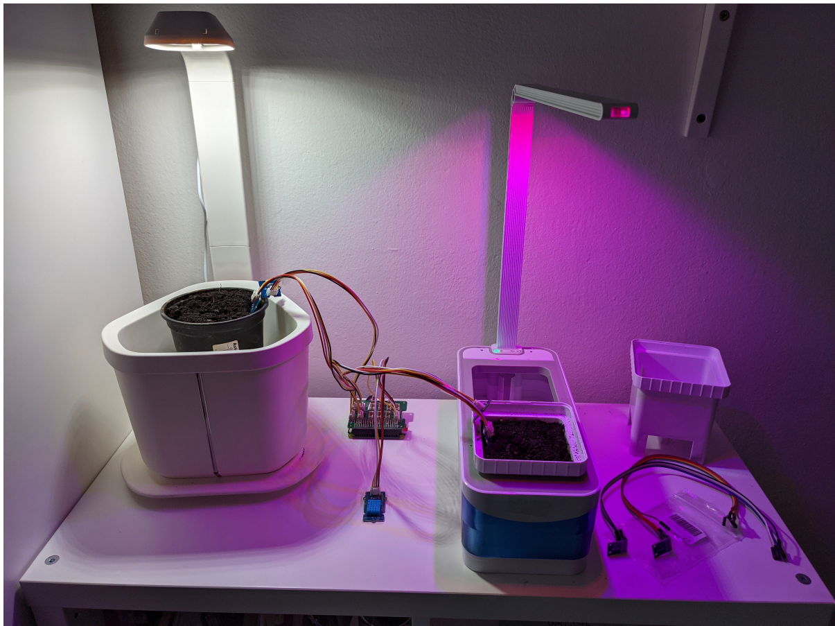
■ Obrázek 5.5 Oba produkční vzorky a mezi nimi právě testované měřicí zařízení. Zde je ještě vidět že nejsou zapojeny všechny senzory, stav je ještě před zasetím bazalky
