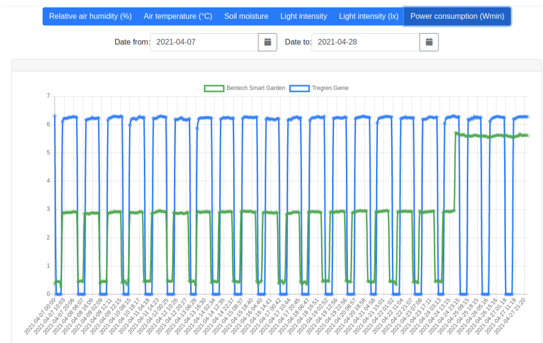
■ Obrázek 4.6 Graf spotřeby elektrické energie obou testovaných květináčů za měřené období (7. 4. 2021 – 28. 4. 2021)
