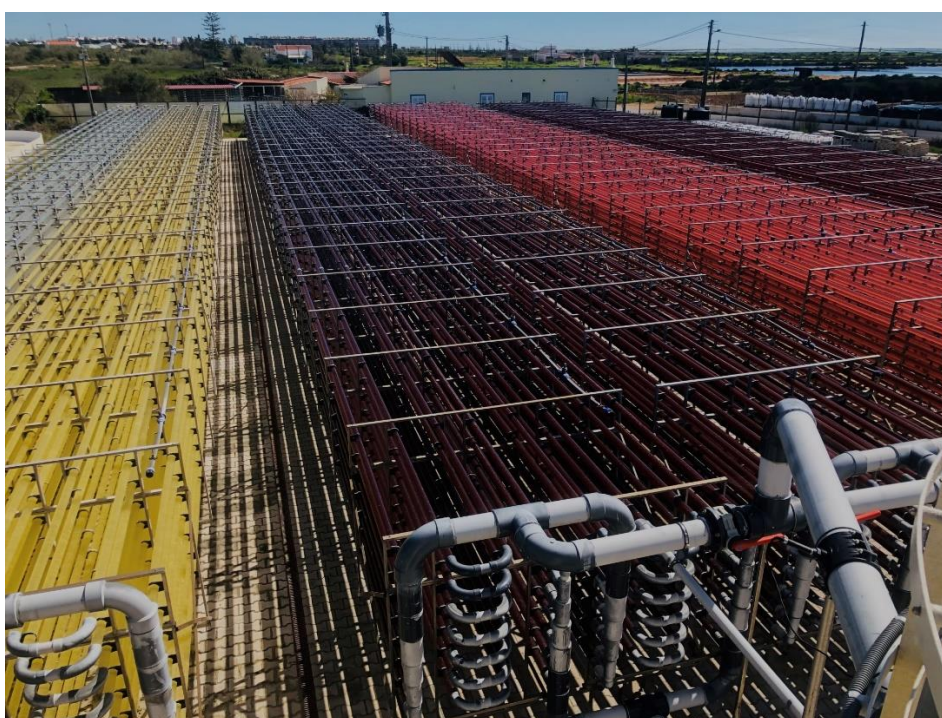
Obrázek 3.8: Horizontální tubulární PBR společnosti Necton [31]
