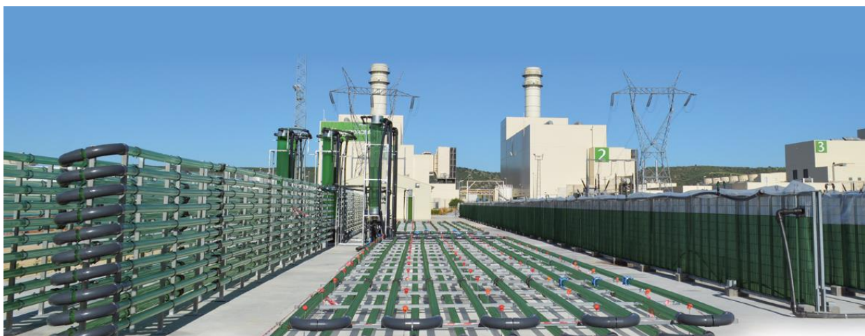
Obrázek 3.3: Tubulární a deskové PBR společnosti AlgaEnergy [29]
