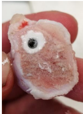
Obrázek 19 - Zkoušený vzorek (implantát fixovaný v kosti cementem)
